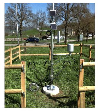
Eine Bodenmonitoringstation wie hier auf Liebegg in Gränichen AG erfasst Niederschlag auf 1,5 m Höhe, Lufttemperatur in 2 m Höhe, Luftfeuchte in 2 m Höhe, Saugspannung in 20 und 35 cm Tiefe sowie Bodentemperatur in 20 und 35 cm Tiefe.
