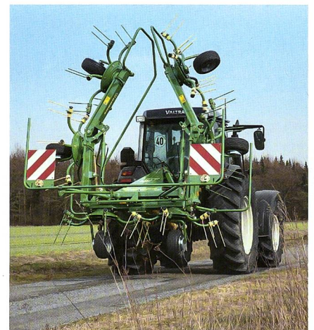
Der Kreiselzettwender überragt das Profil des Traktors und muss daher auch nach vorne mit gut sichtbaren Markierungstafeln ausgerüstet werden. (Werkbild)
