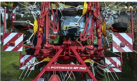
Anbaugeräte und Arbeitsanhänger, die das Zugfahrzeug seitlich überragen, müssen vorne und hinten beidseitig mit Markierungstafeln ausgerüstet sein. (Foto: Ruedi Hunger)
