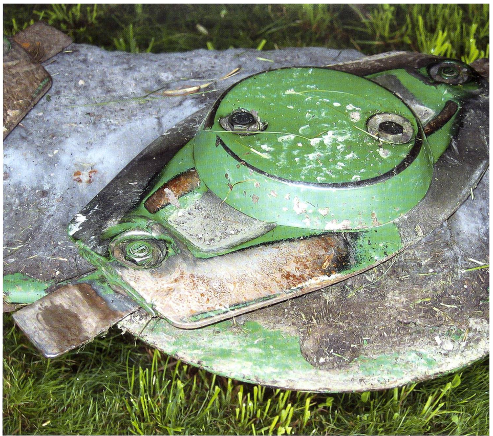
Feuchtes Material, das sich festsetzt, vermindert die Lebensdauer eines Mähwerks.
