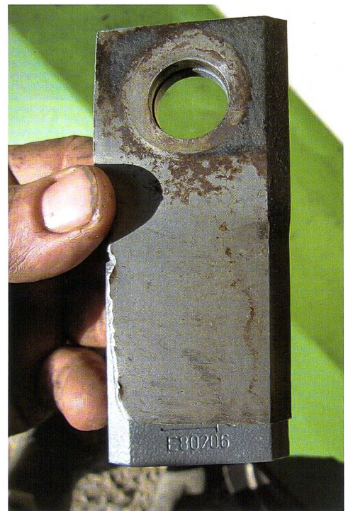
Vorsicht geboten: kopierte Klinge auf Originalklinge gelegt. Differenzen punkto Länge und Lochdurchmesser sind von blossen Auge erkennbar. Man verwende nur autorisierte Ersatzteile.
