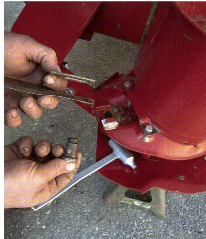
Schnellverschlüsse erleichtern den Klingenwechsel. Sie vereinfachen den Unterhalt.
