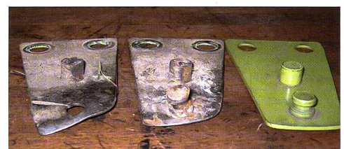
Sind Klingenhalter so abgenutzt wie die beiden links, ist das grobfahrlässig. Rechts ein neuer Klingenhalter.
