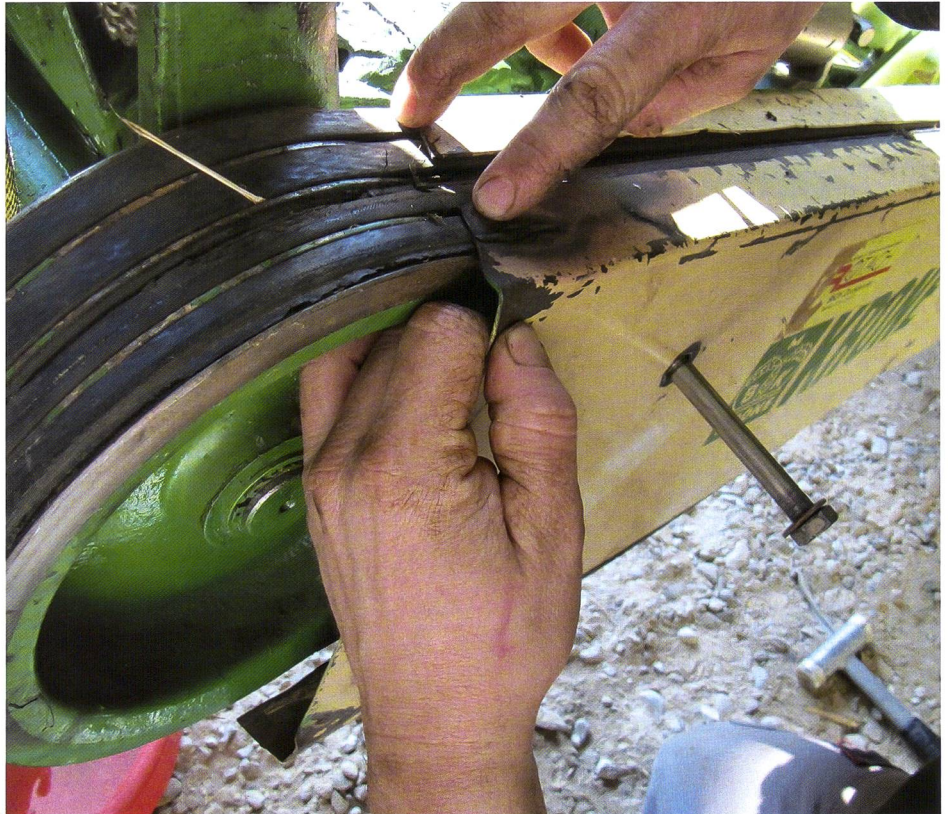
Die defekten Keilriemen halten noch einen Moment. Neue sollten aber vorrätig sein, und der Schutz gehört repariert.
