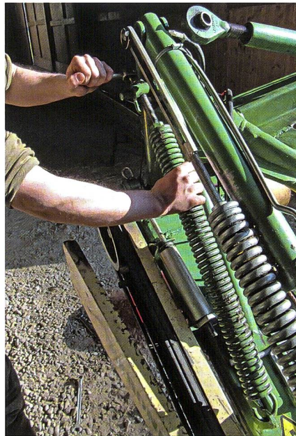
Entlastungsfedern auf Funktion und Risse überprüfen.
