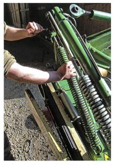
Entlastungsfedern auf Funktion und Risse überprüfen.
