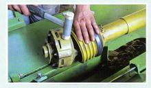
Lösen sich die Beläge beim Bekopfen nicht, so muss das Kupplungspaket ausgetauscht werden.
