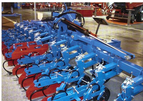
Die Standardhackelemente sind modulierbar aufgebaut und eignen sich für Reihenkulturen zwischen 45 und 80 cm bei Mais, Sonnenblumen, Soja usw.
