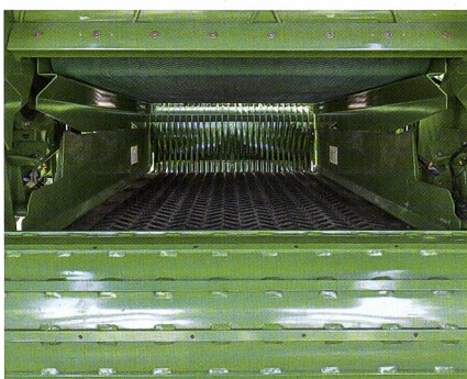
Blick auf die zwei «Zubringerbänder» der Ultima®. Sie übernehmen die Aufgabe der Pressgutpufferung.
