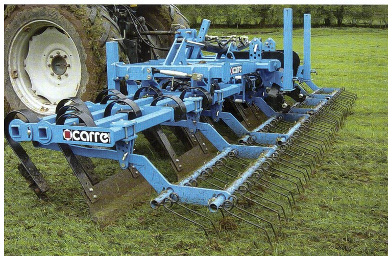
Der Grünlandstriegel von Carré arbeitet mit verschiedenen Elementen und erfüllt damit die gestellten Anforderungen der Grünlandpflege. (Werkfoto)
