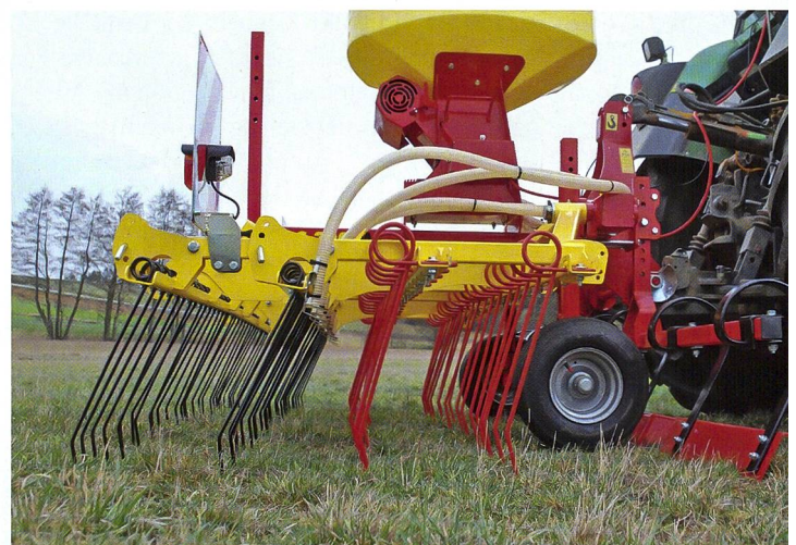
APV hat ein reines Zinkengerät zur Grünlandpflege im Sortiment. Optional ausrüstbar mit einem Sägerät. (Werkfoto)
