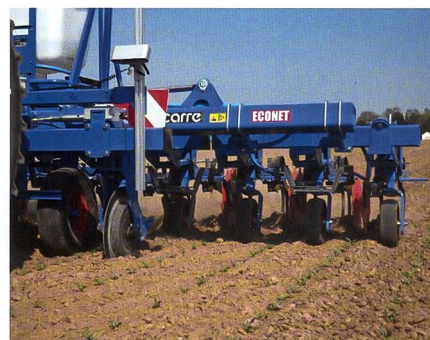
Eine Zweilinsenkamera folgt den Kulturreihen und führt somit das Hackgerät mit hoher Genauigkeit entlang der Reihe.
