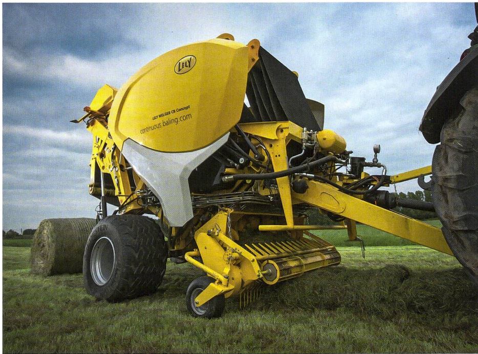
Bei der «CD-Concept» wird die zusätzliche Presskammer im über zwanzig Meter langen Einzelband ausgeformt.
