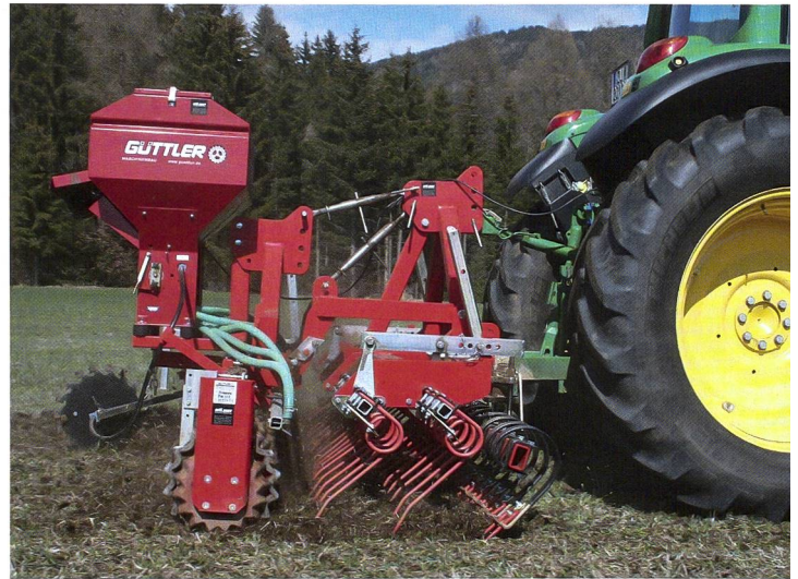
Als Kombination mit der Guttler-Walze gibt es den vorlaufenden Grünlandstriegel und das aufgebaute Sägerät. (Werkfoto)
