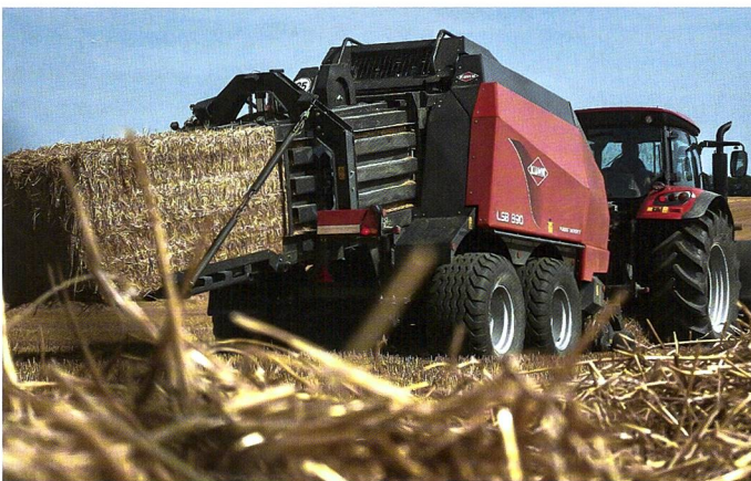
Kuhn hat das Einzugsystem der LSB 890D überarbeitet. Diese verfügt nun über eine 2300mm breite Pick-up mit starren oder schwenkbaren Tasträdern.
