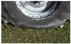
Reifen sind das Bindeglied zum Boden: entsprechend sollte der Reifendruck wenn immer möglich der «Fahrbahn» angepasst werden, oder ein entsprechender Reifen erlaubt ein Fahren mit permanent tiefem Reifendruck.
