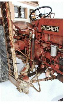
Die Schnellmontage des Mähapparates am Bucher-Traktor ist gut gelöst; eine automatische Ausklinkvorrichtung bewirkt den sofortigen Stillstand des Traktors, wenn der Messerbalken an ein Hindernis stösst.
