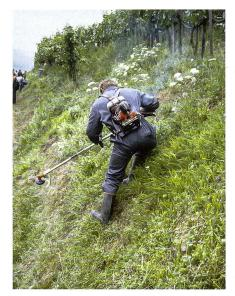
Dies ist ein gefährlicher Einsatz. Es fehlen geeignetes Schuhwerk und der Schutz hinter dem Arbeitswerkzeug.
