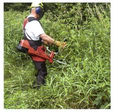
Für sicheres und ergonomisches Arbeiten mit Freischneidern muss das Gerät ausbalanciert und auf die Person eingestellt sein. Es ist die persönliche Schutzausrüstung zu tragen und die Sicherheitsdistanzen sind einzuhalten.
