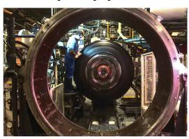
Das Glätten der äussersten Lagenschicht mittels Roller.
