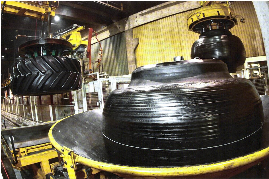
Traktorreifen vor und nach der Konformation in der Michelin-Reifenfabrikation im spanischen Valladolid. (Bilder: Werkbilder/Dominik Senn)
