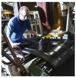
Die Karkasslage wird auf den Reifenumfang abgelängt und zusammengeklebt.
