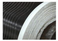
Eine aufgerollte Karkasslage, zusammengesetzt aus einer Gummimischung und Textilien.
