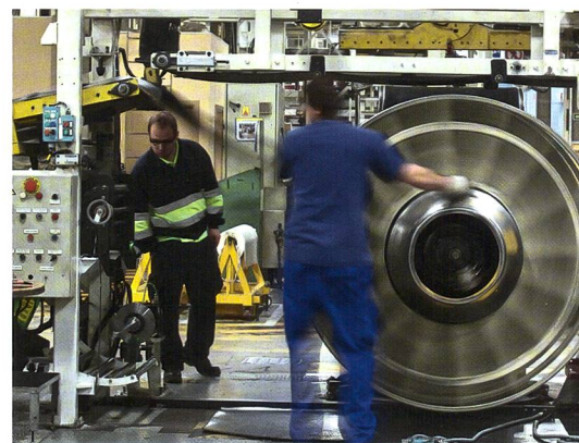
Nach erfolgreicher Konformation werden verschiedene Gürtellagen aus Textil, Stahl und Laufflächengummi aufgelegt.
