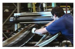
Die in einem separaten Verfahren hergestellten Wulstkerne werden für die Auflage auf die Karkasslage auf Band gelegt.
