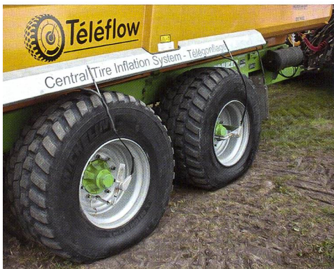
Mittels Reifendruckregelanlage kann beim CargoXBib High Flotation der Fülldruck gezielt angepasst werden.
