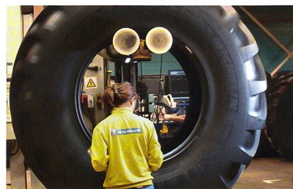
Am drehenden Reifen nimmt eine Mitarbeiterin diverse Messungen und Sichtprüfungen vor – Bestandteil der Qualitätskontrolle.
