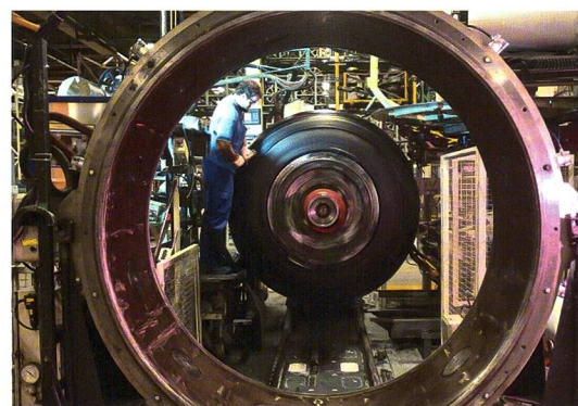
Das Glätten der äussersten Lagenschicht mittels Roller.
