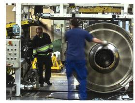
Nach erfolgter Konformation werden verschiedene Gürtellagen aus Textil, Stahl und Laufflächengummi aufgelegt.
