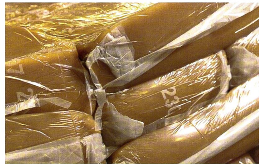
Die Haupta Ausgangsprodukte sind natürlicher und (gelb) synthetischer Kautschuk.
