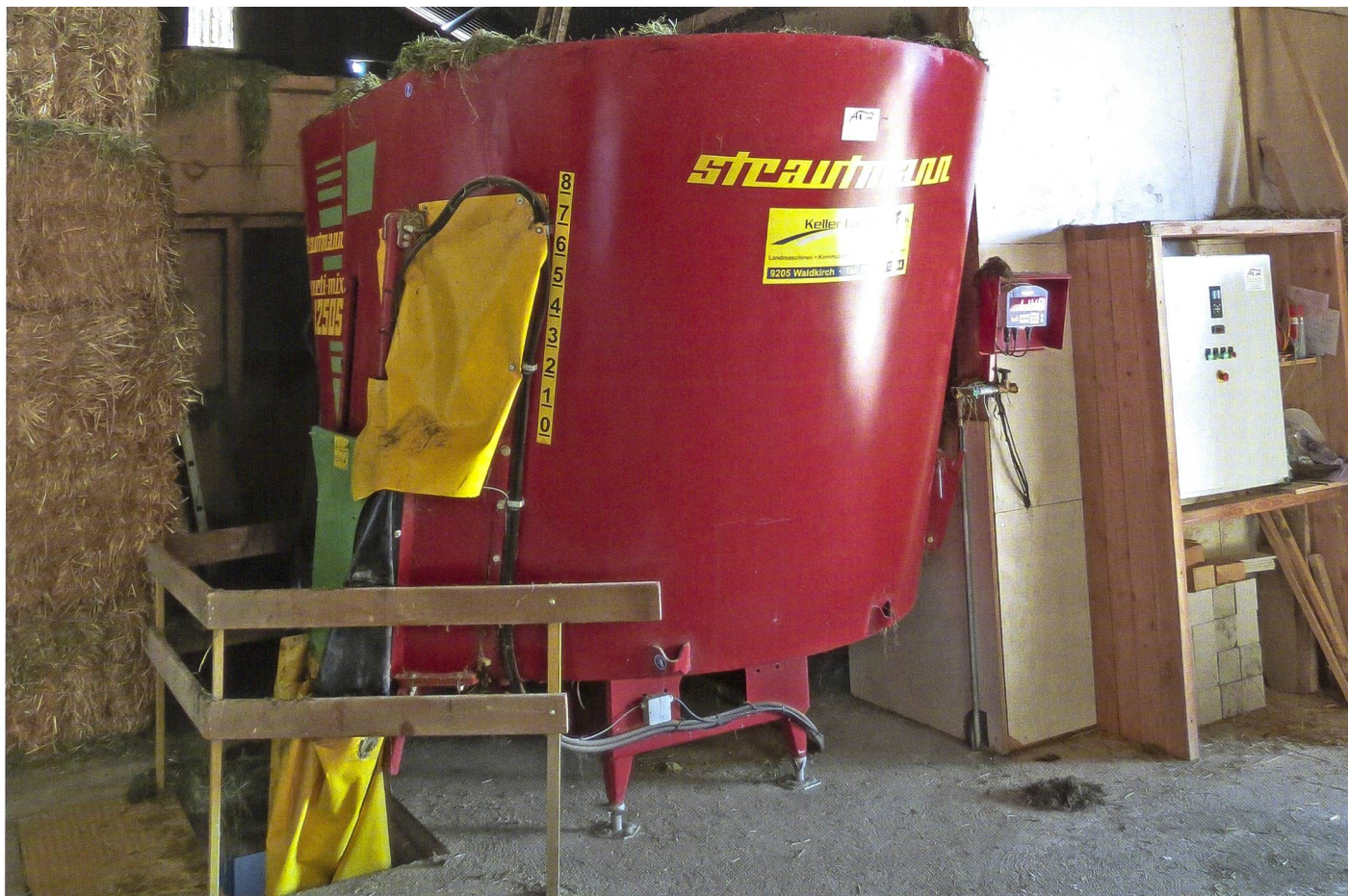
Futtermischanlage auf dem Betrieb von Martin Abderhalden, kompakt und ideal positioniert. Links ist der Austrag direkt über dem Abwurfschacht, durch den das Verteilfahrzeug beschickt wird. Unter der gelben Plane befindet sich geschützt der Schiebersensor. (Bilder: Martin Abderhalden)
