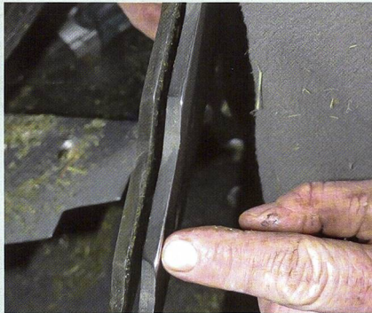
Ein sauberer Schliff ohne überhitzte Stellen ist ein Muss. Der Finger zeigt auf eine stumpfe Stelle. Dahinter das geschliffene Ersatzmesser.
