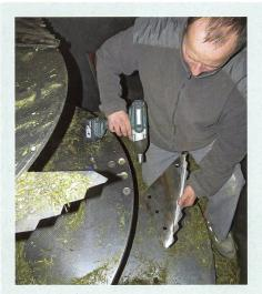
Zum Nachschärfen müssen die Messer mit einem Akkuschlagschrauber ausgebaut werden.
