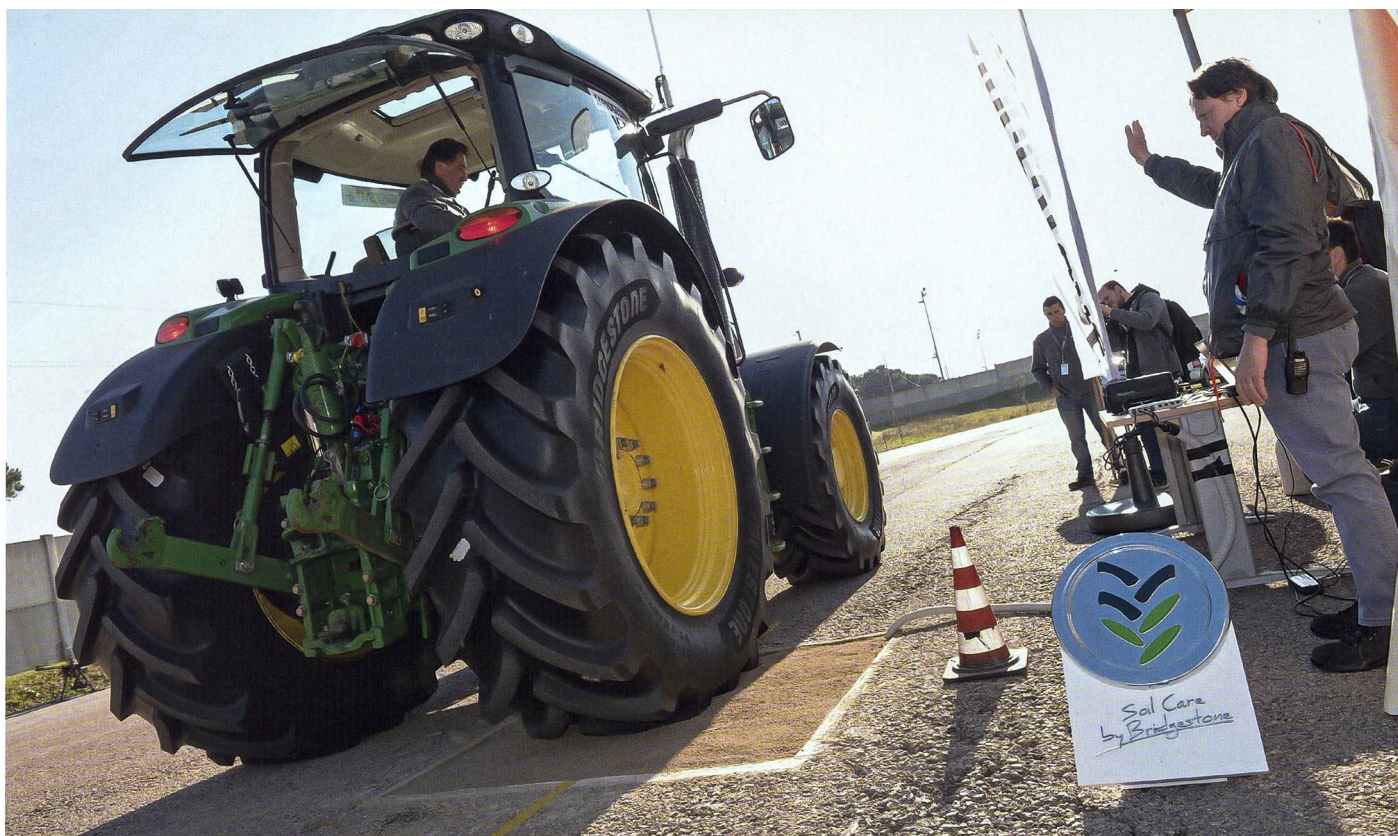
Der VT-Tractor drückt seine grosse Aufstandsfläche in den Sand, die Ingenieure nehmen durch Sensoren Mass unter der Versuchsfläche. (Bilder: zVg)
