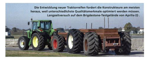
eine Reduktion beim Schlupf zu erzielen. Bei 0,8 bar Reifenluftdruck wurde pro Tag im Vergleich zum zweitbesten Improved Flexion (IF)-Reifen (allerdings nur) 20 Aren mehr gepflügt (bezogen auf eine Ackerfläche von ca. 40 Hektaren).
