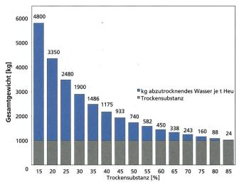
Abb. 20: Abzutrocknende Wassermenge.
