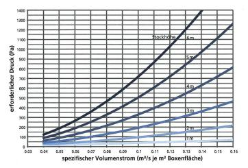
Abb. 6: Statischer Druck bei Wiesenheu in Boxen.
