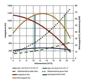
Abb. 7: Druck-Volumen-Diagramm mit den Kennlinien für Anlagedruck, Leistungsaufnahme und Wirkungsgrad.
