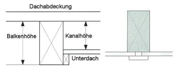
Abb. 11: Einbau des Unterdaches, optimale Kanalhöhe kleiner als Balkenhöhe (links), Kanalhöhe = Balkenhöhe (rechts).
