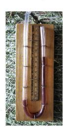
Abb. 23: Messen des statischen Druckes. Ein Schlauchende wird unterhalb des Boxenrostes verlegt; 1 mm Wassersäule entspricht ca. 10 Pa.
