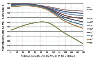
Abb. 12: Ausrichtungsfaktoren gegenüber Südrichtung für die Sommermonate.
