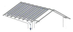
Abb. 9: Sonnenkollektor (Dachabsaugung) bei Sparrendach mit traufenseitigem Sammelkanal.
