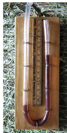
Abb. 23: Messen des statischen Drukkes. Ein Schlauchende wird unterhalb des Boxenrostes verlegt; 1 mm Wassersäule entspricht ca. 10 Pa.
