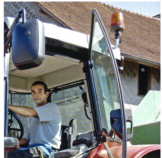
Gelbes Gefahrenlicht (auch Drehlicht genannt) wird im Fahrzeugausweis eingetragen. Es darf auf dem Traktor nur eingeschaltet werden in Kombination mit überbreiten Arbeitsgeräten oder beim Einsatz im Winterdienst.
