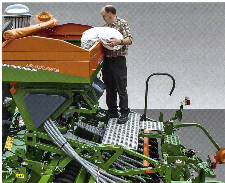
Amazone achtete bei der AD-P-Special im Rahmen des Gesamtkonzeptes auf die gute Zugänglichkeit zum Dosierer und auf den ungehinderten Aufstieg zum Saatgutbehälter.
