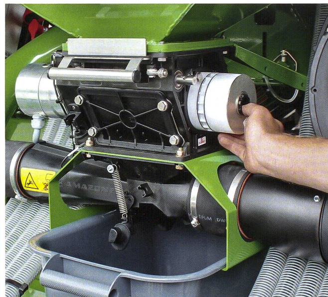
Der aus der Grossflächensätechnik bekannte elektronische Dosierer ist nun auch in der neuen AD-P-Special verbaut.
