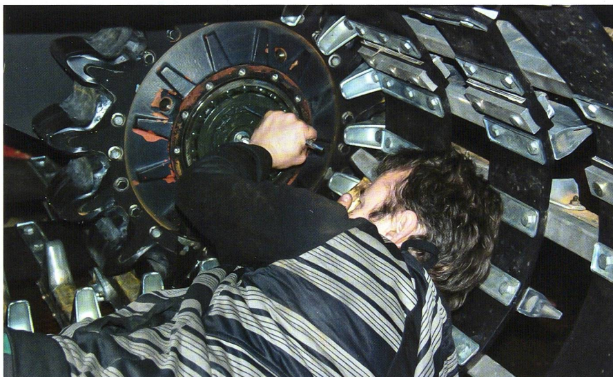
Die Stege aus Aluminiumprofilen sind mit angenieteten Stahlschienen verstärkt.
