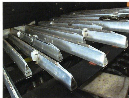
Die Stege aus Aluminiumprofilen sind mit angenieteten Stahlschienen verstärkt.
