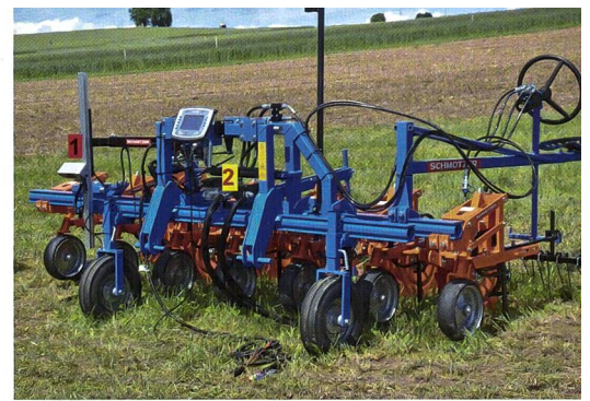
Optitronic-Kameraerfassungssystem (1) in Verbindung mit einem hydraulisch verschiebbaren Geräterahmen aus dem Hause Schmotzer.
