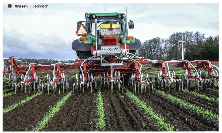
Die Kongskilde-«Vibro Crop Intelli»-Hackmaschine kann mit Section Control ausgerüstet werden, welche über ein GPS-Terminal in der Schlepperkabine gesteuert wird. Ein neuer hydraulisch verschiebbarer Rahmen steuert die Maschine mit Unterstützung einer Kamera in der Reihe, mit einer Genauigkeit von bis zu ca. 2,5 cm.
