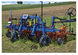
Optitronic-Kameraerfassungssystem (1) in Verbindung mit einem hydraulisch (2) verschiebbaren Geräterahmen aus dem Hause Schmotzer.
