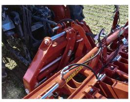
Hydraulisch verschiebbarer Rahmen für die automatischen Gerätesteuerung (Einböck).
