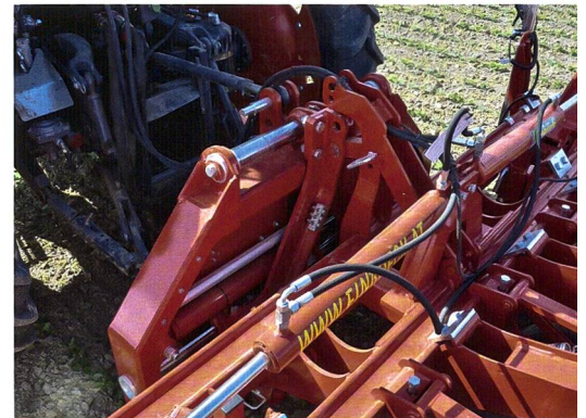
Hydraulisch verschiebbare Rahmen für die automatische Gerätesteuerung (Einböck).
