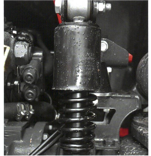
Die Kabine ist auf einem Federsystem aufgebaut, das zusammen mit dem luftgefederten Sitz Stösse und Vibrationen absorbiert.
