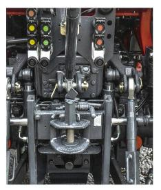
Geschützt hinter der Anbaukonsole verlaufen die Lenkstange der Hinterachse und die Zusatzzylinder des Hubwerks.
