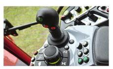
Vorne: LDrive-Controller für Beschleunigung bzw. Motordrückung; umgeben von den Funktionstasten für Langsam-Fahrt, Tempomat und Fussgas-Modus. Hinten: Allrad und Differentialsperre.
