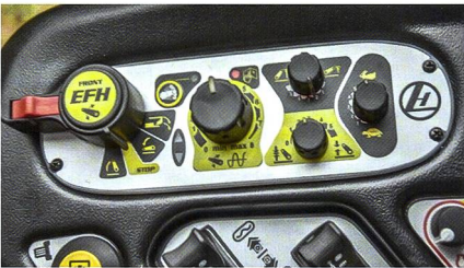
Analog zur EHR lässt sich auch die EFH (Fronthydraulik) einfach mit selbsterklärenden Symbolen steuern.
