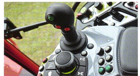
Vorne: LDrive-Controller für Beschleunigung bzw. Motordrückung; umgeben von den Funktionstasten für Langsam-Fahrt, Tempomat und Fussgas-Modus. Hinten: Allrad und Differentialsperre.
