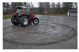
Resultat der Lenkhinterachse, ein um rund zwei Meter reduzierter Wendekreisdurchmesser.
