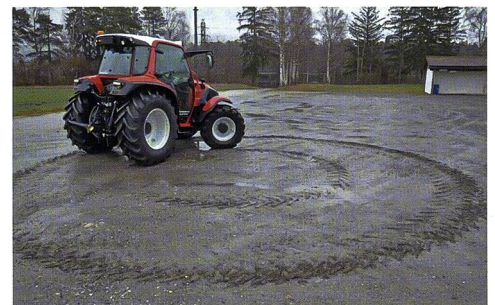
Resultat der Lenkhinterachse, ein um rund zwei Meter reduzierter Wendekreisdurchmesser.
