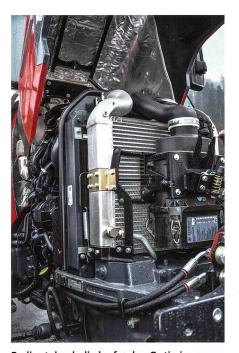
Bedingt durch die laufenden Optimierungen am Motor, ist es eng geworden unter der Motorhaube.
