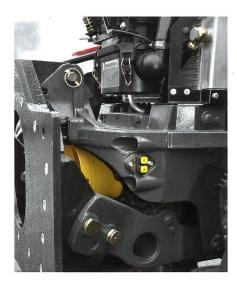
Kompakt gebaut ist auch die Fronthydraulik, im Bild mit montierter Grundplatte für den Schneepflug.
