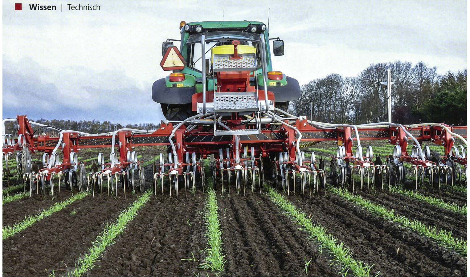
Die Kongskilde-«Vibro Crop Intelli»-Hackmaschine kann mit Section Control ausgerüstet werden, welche über ein GPS-Terminal in der Schlepperkabine gesteuert wird. Ein neuer hydraulisch verschiebbarer Rahmen steuert die Maschine mit Unterstützung einer Kamera in der Reihe, mit einer Genauigkeit von bis zu ca. 2,5 cm.
