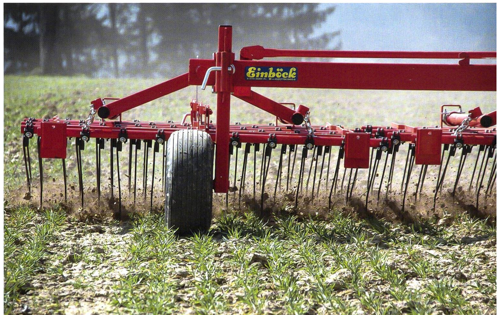
Der Hackstriegel zeigt eine gute Wirkung auf Unkräuter im Keimblatt- bis zum 2-Blatt-Stadium.
