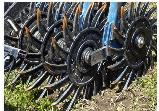
Die in den Boden einstechenden Werkzeuge der Rollhacke reissen Unkräuter aus oder verschütten sie.
