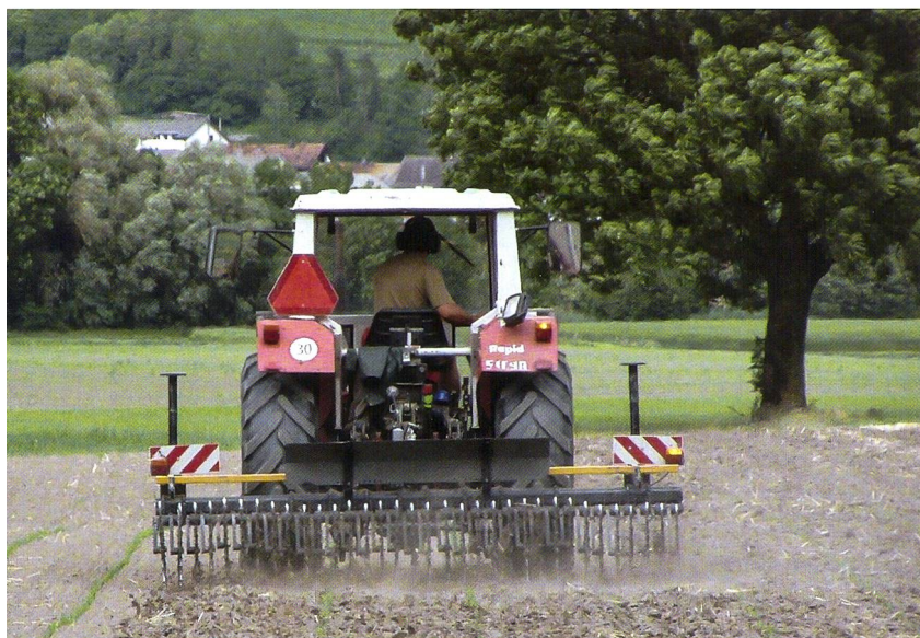
Die Rollhacke wird reihenunabhängig eingesetzt und erzielt eine ähnliche Wirkung wie der Striegel.
