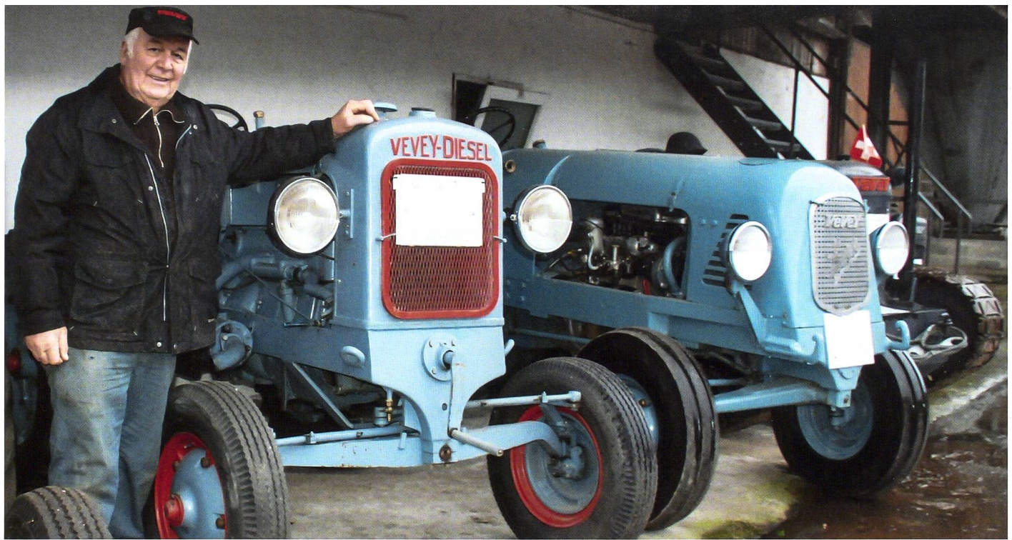
Ueli Haslebacher neben seinem Vevey V2 von 1939 mit CLM-CR-2-2-Takt-Gegenkolbenmotor, daneben der S.A. von 1945 mit Saurer-CBD-C-485-D-Motor, dahinter knapp sichtbar der Flugzeugschlepper MC 3. (Bilder: Dominik Senn)
