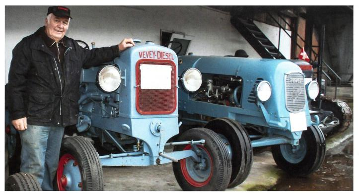
Ueli Haslebacher neben seinem Vevey V2 von 1939 mit CLM-CR-2-2-Takt-Gegenkolbenmotor, daneben der S.A. von 1945 mit Saurer-CBD-C-485-D-Motor, dahinter knapp sichtbar der Flugzeugschlepper MC 3. (Bilder: Dominik Senn)
