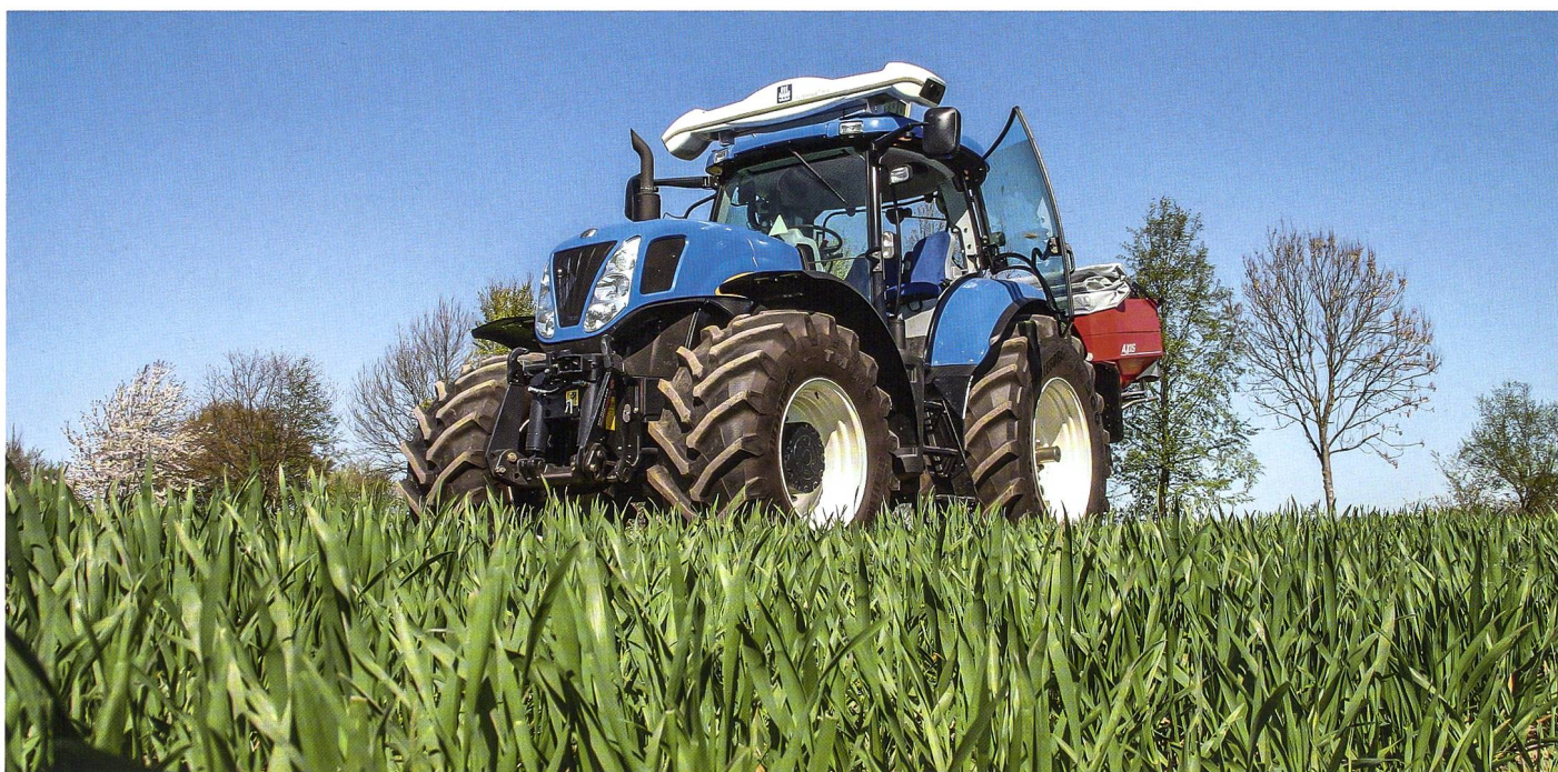
Sensorsysteme erfassen immer nur eine Teilfläche der Arbeitsbreite eines modernen Düngerstreuers. (Bild: Yara)
