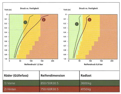
Abb. 4: Bodendruck unter einem Güllefass bei unterschiedlichem Reifendruck.
