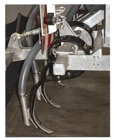
Ackerinjektor mit Blattfederzinken und Gülleablage unmittelbar hinter dem Zinken. Rückverfestigung und Überdeckung mittels Rohrtragwalze.
