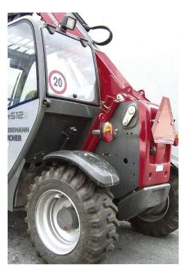
Mit Ausnahme der rechten Seite ist die Übersicht beim Teleskoplader gut. Ein seitlich angeordneter Motor verkürzt das Fahrzeug, erfordert aber mehr Heckgewicht.
