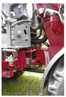
Hoflader mit starren Achsen verfügen meistens über eine Pendelknicklenkung. Solche mit einem starren Gelenk sind oft mit einer Pendelhinterachse ausgerüstet.
