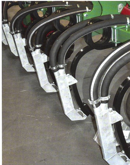
Lomma verbindet den Federzinken mit einem massiven Injektor und legt die Gülle auf Bearbeitungstiefe ab.
