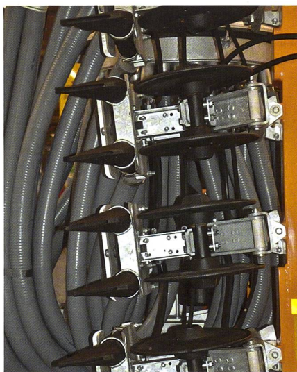
Der hochgeklappte Tragbalken von Veenhuis/Kverneland gibt den Blick frei auf das pendelnd angebaute Doppelscheibenelement mit Gummitüllen.
