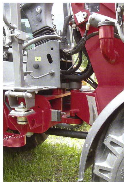
Hoflader mit starren Achsen verfügen meistens über eine Pendelnicklenkung. Solche mit einem starren Gelenk sind oft mit einer Pendelhinterachse ausgerüstet.
