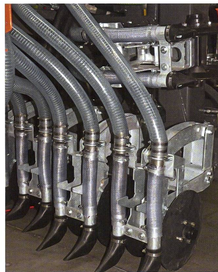
Die parallelgeführten Arme sind mittels Gummi-Torsionsfeder mit dem Rahmen verbunden.
