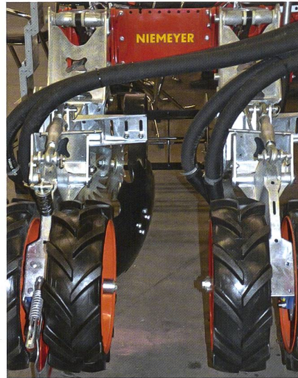
Niemeyer verbindet das Strip-Till-Element mit einem doppelt gespiesenen Gülleinjektor.
