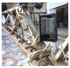
Hackmaschine erfasst Daten Das System «AGROGEOVISIO» ist ein Führungssystem mit Computer Vision und zentimetergenauem GPS, das die Steuerung einer Hackmaschine in allen Anbausituationen ermöglicht. Die Hackmaschine wird durch ein
