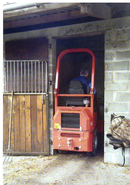
Kleine Hofladertypen weisen zum Teil Gesamtbreiten unter einem Meter auf und können fast durch jedes Loch «schlüpfen».
