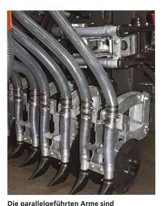
Die paralleigeführten Arme sind mittels Gummi-Torsionsfeder mit dem Rahmen verbunden.
