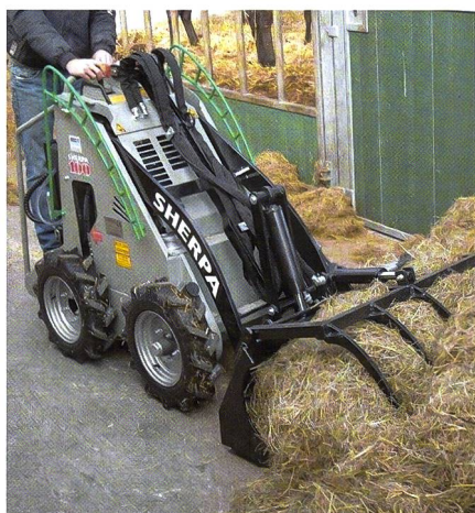
Dieser kleine, elektrisch betriebene Kompakt-lader verfügt über einen «Stehplatz».
