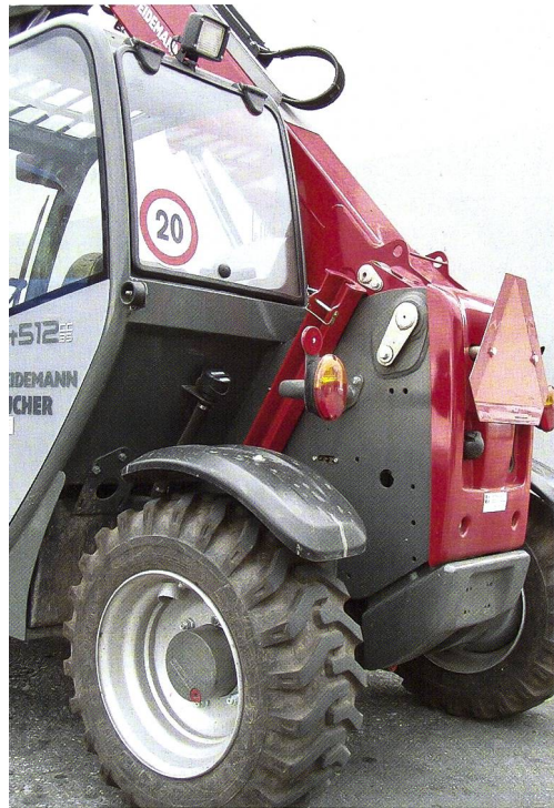
Mit Ausnahme der rechten Seite ist die Übersicht beim Teleskopklader gut. Ein seitlich angeordneter Motor verkürzt das Fahrzeug, erfordert aber mehr Heckgewicht.
