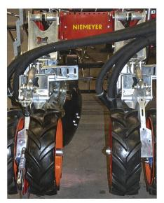
Niemeyer verbindet das Strip-Till-Element mit einem doppelt gespiesenen Gülleinjektor.
