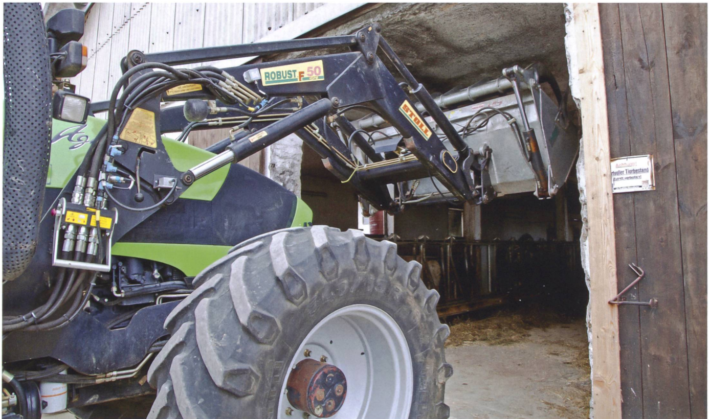
Das elektronische Begrenzen einer Frontladerbewegung ist zuverlässig und schützt Lader und Gebäude vor möglichen Kollisionen. (Werkbild: Fliegl)
