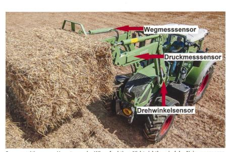
Sensorpositionen zur Umsetzung der Wiegefunktion. Nicht sichtbar sind der Neigungssensor und die Elektronikbox. (Bild: Ruedi Hunger)
