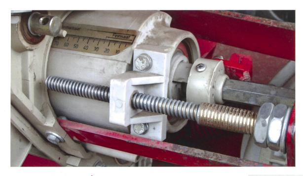
Zellraddosierung, Herzstück der pneumatischen Sämaschine. (Bild: Ruedi Hunger)
