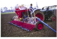
Erfindung der pneumatischen Sätechnik durch Heinrich Weiste. (Bild: dlz Agrarmagazin)
