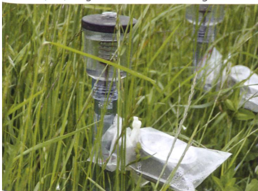
Bodenfeuchtesensoren helfen, das Gefühl für Veränderungen der Bodenfeuchte unter der Bodenoberfläche zu entwickeln.
