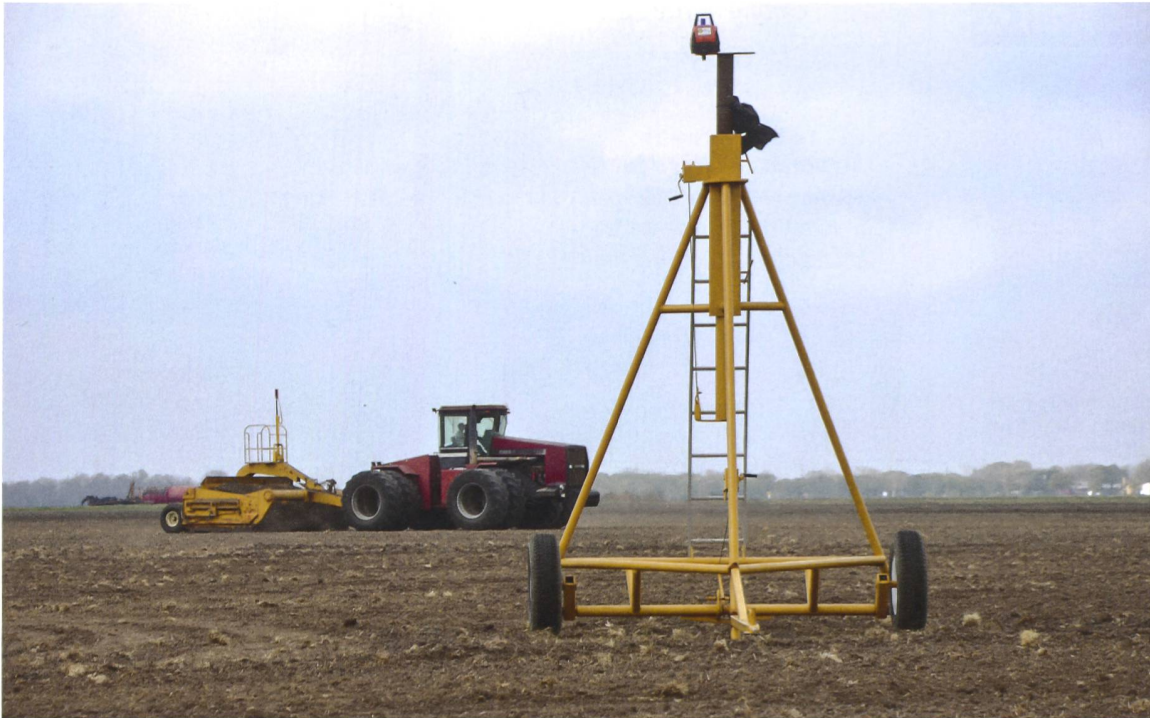
Voraussetzung der Oberflächenbewässerung auf grossen ebenen Flächen ist ein flächendeckender Einsatz des «Grader» als Erdhobel. (Bilder: Ruedi Hunger)
