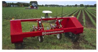
Die Agrarplattform von Kongskilde ist ein «Geräteträger» zur automatisierten und halbautomatisierten Ausführung von Arbeiten wie beispielsweise mechanische Unkrautregulierung, Präzisionsaussaat und Kulturpflege.
