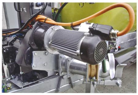
Fliegl-FFC – der elektrische Pumpenantrieb auf dem Güllefass ist die Grundlage für eine nährstoffeffiziente Gülledüngung.
