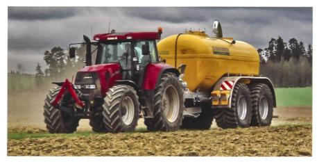
Ein im Fass integrierter NIR-Sensor misst den Nährstoffgehalt in der Gülle. Mit diesen Daten kann die Sollausbringmenge gesteuert werden.
