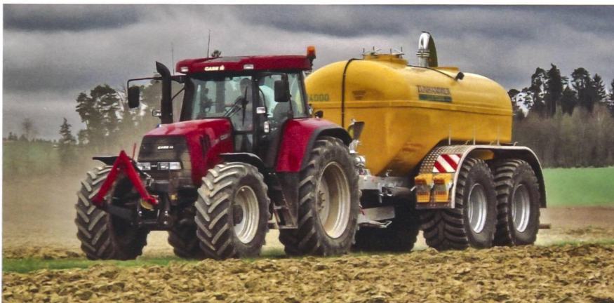
Ein im Fass integrierter NIR-Sensor misst den Nährstoffgehalt in der Gülle. Mit diesen Daten kann die Sollausbringung gesteuert werden.
