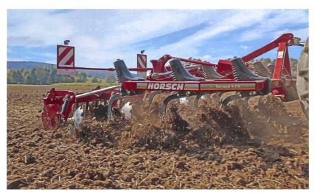
Dem Bestreben, die Einzugsstrecke möglichst kurz zu halten, kommt die EHR-dw mit Druck auf die Unterlenker entgegen.
