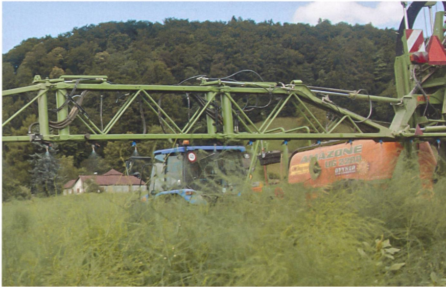
Beim Transport möchte man wenig Wasser mitführen. Im Pflanzenbestand aber muss das Wasser eine gleichmässige Benetzung garantieren, wobei je nach Pflanzenschutzmittelgruppe und Behandlungsspektrum sowie Bestandesdichte unterschiedliche Anforderungen gelten. (Foto: Ueli Zweifel)
