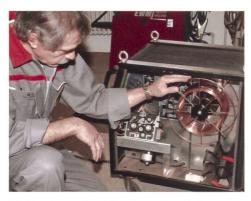
Blick ins Innere des Schweissgeräts mit dem Drahtvorschubmechanismus.
