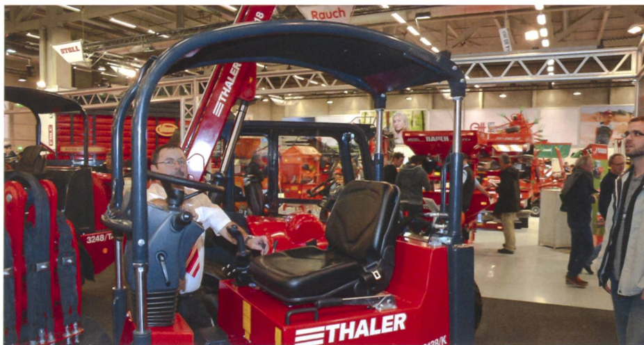
Gleichzeitig haben Weidemann und Thaler eine Lösung gefunden, wie das Schutzdach bei niedrigen Durchfahrten abgesenkt werden kann. Bei Weidemann gibt es ein hydraulisch faltbares Dach, Thaler senkt das Dach über 4 Hydraulikzylinder. Beide Systeme werden über eine Zweihandbedienung gesteuert. (Bilder: BUL)
