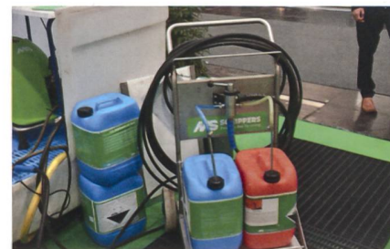
Werden Gefahrstoffe in einem geschlos- senen System angewendet, besteht keine Gefahr für Drittpersonen und Kinder. Mit diesem Zubehör lassen sich Abluftkamine sicher und effizient reinigen.
