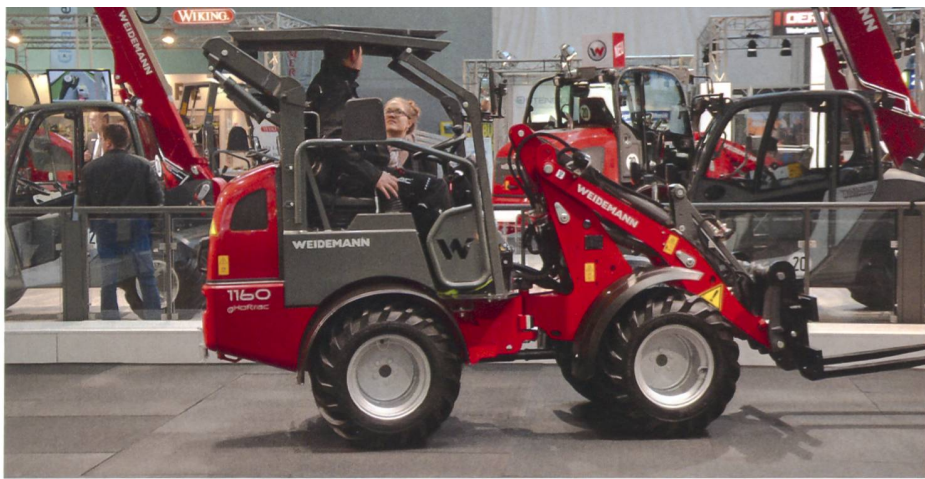
Gleichzeitig haben Weidemann und Thaler eine Lösung gefunden, wie das Schutzdach bei niedrigen Durchfahrten abgesenkt werden kann. Bei Weidemann gibt es ein hydraulisch faltbares Dach, Thaler senkt das Dach über 4 Hydraulikzylinder. Beide Systeme werden über eine Zweihandbedienung gesteuert. (Bilder: BUL)
