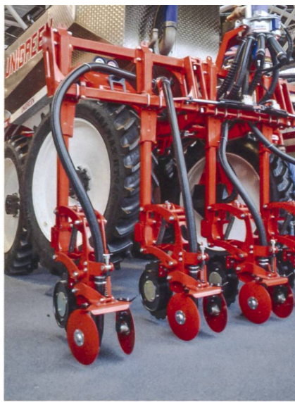
Gülle direkt beim Ausbringen einarbeiten, stösst auch in Italien auf wachsendes Interesse (Gaspardo-Applicator).
