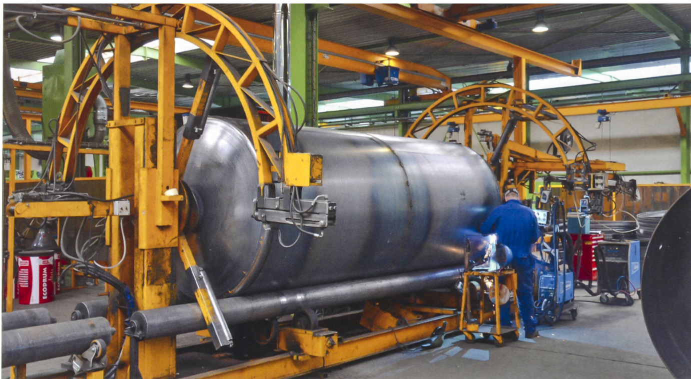
In der Vormontage werden Bleche an digital gesteuerten Pressen rundgebogen und je nach Volumenbedarf mittels Schweissroboter zusammengesetzt; Deckel und Zubehör werden manuell verschweisst, worauf der Behälter innen und aussen feuerverzinkt wird. (Bilder: Werkbilder/Dominik Senn)
