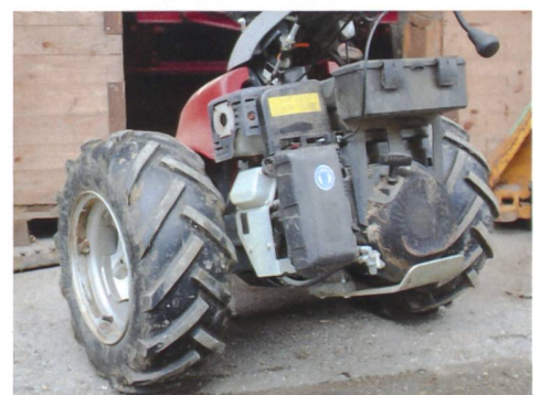
Kleinmotoren ohne Druckumlaufschmierung können bei zu wenig Öl im Hangeinsatz schnell Schaden nehmen. Vor Arbeitsbeginn sollte der Ölstand daher im oberen Bereich der Minimal- und Maximalmarke liegen.
