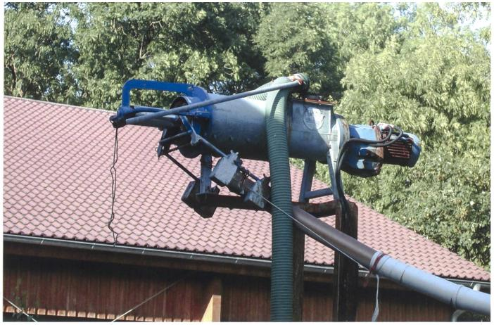
Der Zahn der Zeit hat seine Spuren an diesem Gülleseparator hinterlassen. Weil die Wellendichtungen am Getriebemotor sicher nicht mehr «neuwertig» sind und das Gerät im Freien steht, sind eine regelmässige Ölkontrolle und ein rechtzeitiger Ölwechsel ratsam, auch wenn es beschwerlich ist.
