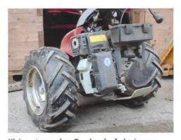
Kleinmotoren ohne Druckumlaufschmierung können bei zu wenig Öl im Hangeinsatz schnell Schaden nehmen. Vor Arbeitsbeginn sollte der Ölstand daher im oberen Bereich der Minimal- und Maximalmarke liegen.
