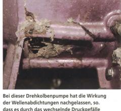
dass es durch das wechselnde Druckgefälle zwischen Pumpenraum und Getriebegehäuse zu einer Vermischung zwischen Öl mit Gülle gekommen ist. Dies führte zu einem Totalschaden der Pumpe mit viel Rost und geborstenem Getriebegehäuse.
