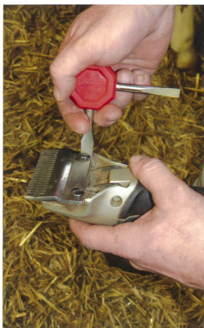
Der Klingenwechsel erfolgt mit dem speziellen Schraubenzieher. Obermesser entspannen, beide Schrauben eine Umdrehung lösen, und beide Messer lassen sich schnell ausbauen.
