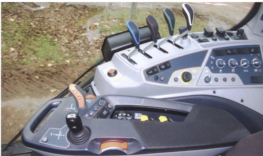
Neue Valtra-Active-Bedienkonsole (ohne Monitor) mit Load-Sensing-Hydraulik, Hydraulik-Assistenten und getrenntem Ölhaushalt für Hydraulik und Getriebe. Maximal kann der Valtra Active mit vier mechanischen und zusätzlich drei elektronischen Steuergeräten ausgestattet werden. Das Getriebe wird von einem Bordrechner gesteuert, und der Schlepper kann mit dem Fahrhebel (vorne rechts) im Automatikbetrieb oder im manuellen Modus gefahren werden.
