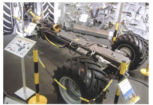
Chassis des Triebachsanhänger X-trailer (Trachsel Technik AG, Mettmenstetten ZH).
