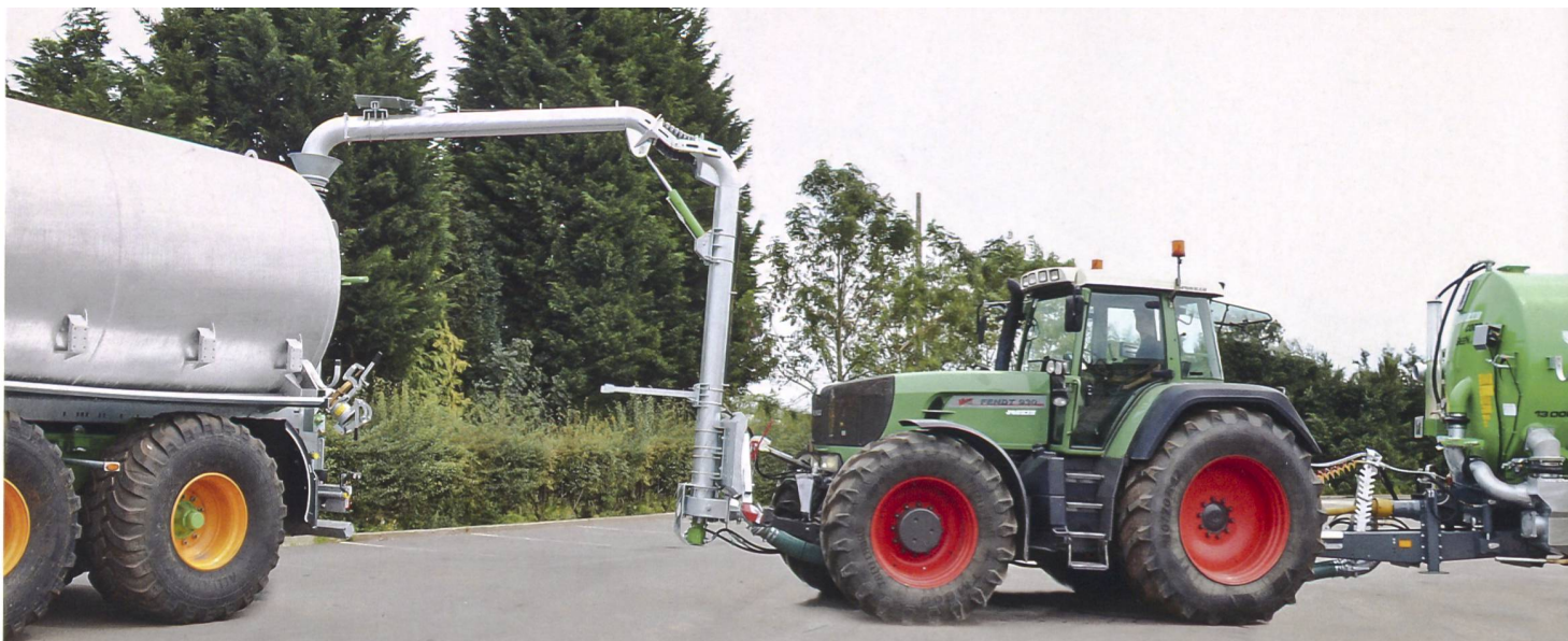
Der neue gelenkige Ansaugarm von Joskin zur Befüllung des Ausbringfasses; der Turbofüller auf der Grundkonstruktion im Hubwerk beschleunigt die Gülle in die Kanalisation unter dem Traktor durch ins angehängte Fass. (Bilder: Werkbilder/Dominik Senn)
