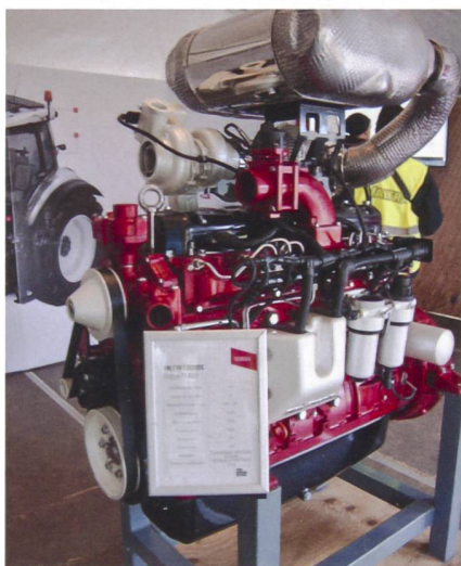
7,4-Liter-AWF-Dieselmotor der neuesten Generation von Agco Power. Die Abgasreinigung beruht ausschliesslich auf SCR-Technologie mit adBlue-Zumischung und Oxydationskatalysator.
