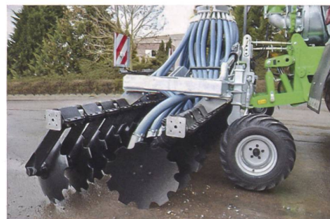
Der komplett feuerverzinkte Scheibengrubber Terradisc zur Gülleneinarbeitung.
