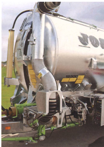
Der neue seitliche Jumbo-Auslegerarm (hier in Transportposition) kann rechts oder links der Fahrtrichtung angebaut werden.
