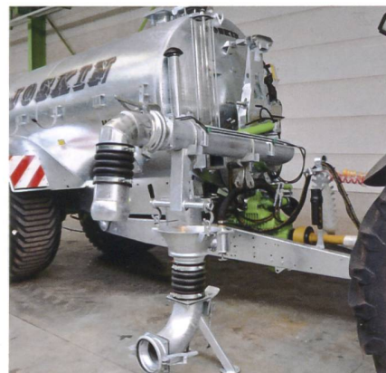
Der Ansaugarm wird abgesenkt, bis er auf dem Boden steht. Jetzt kann die Position vor dem Ansaugen eingestellt werden.
