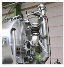
Der Trichter wird mechanisch beim Ansaugbereich positioniert.
