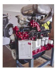
7,4-Liter-AWF-Dieselmotor der neusten Generation von Agco Power. Die Abgasreinigung beruht ausschliesslich auf SCR-Technologie mit adBlue-Zumischung und Oxydationskatalysator.
