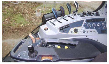
Neue Valtra-Active-Bedienkonsole (ohne Monitor) mit Load-Sensing-Hydraulik, Hydraulik-Assistenten und getrenntem Ölhaushalt für Hydraulik und Getriebe. Maximal kann der Valtra Active mit vier mechanischen und zusätzlich drei elektronischen Steuergeräten ausgestattet werden. Das Getriebe wird von einem Bordrechner gesteuert, und der Schlepper kann mit dem Fahrhebel (vorne rechts) im Automatikbetrieb oder im manuellen Modus gefahren werden.
