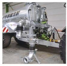
Der Ansaugarm wird abgesenkt, bis er auf dem Boden steht. Jetzt kann die Position vor dem Ansaugen eingestellt werden.
