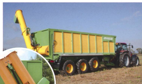
Die Überladeschnecke am Rollband-Abschiebewagen einsatzbereit ... und in Transportstellung.
