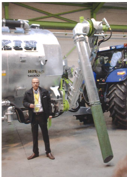
Produktspezialist Michael Peeters führt den selbsttragenden Ansaugarm am Delta 14000 vor.
