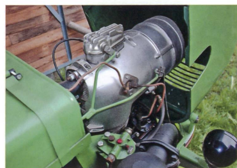
Oben: Die Kulissenschaltung ist vom Motormäher übernommen worden.
