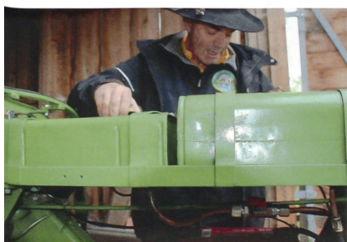
Unten: Links der Öltank für die Motorschmierung, rechts der Dieseltank.
