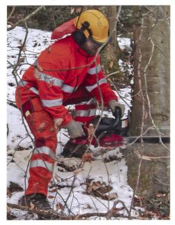
Wer entlang von Strassen arbeitet muss Kleidung gemäss EN 20471 tragen, d.h. mit Leuchtorange oder -gelb und Reflexstreifen.
