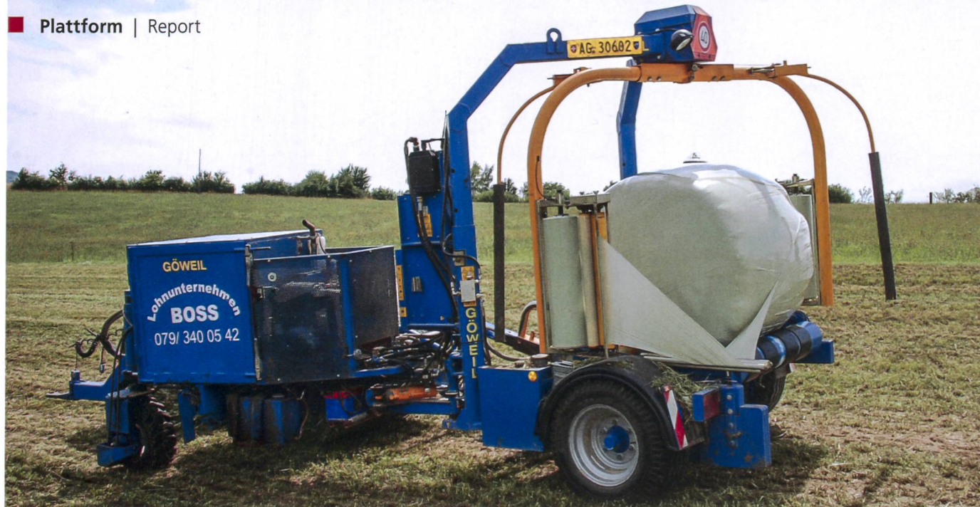
Mittels Aufbaumotor hat Lohnunternehmer Fritz Boss in der Konstruktionswerkstätte von Jürg Müller den Göweil 2050 mit Doppelwickelarm zum autonomen Ballenwickler umfunktioniert. (Bilder: Dominik Senn)
