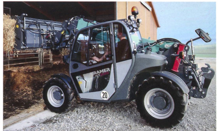
Unten: Hohe Nutzlast bei kompakten Abmessungen kennzeichnen den Kompaktteleskopler KT225.
