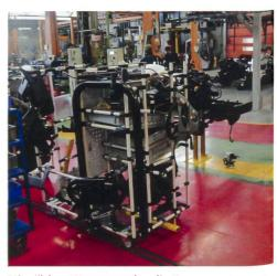
Mit solchen Wagen werden die Komponenten aus dem Warenhaus zur Montage transportiert.
