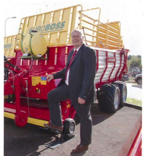
Geschäftsführer Hanspeter Hitz betätigt beim EuroBoss 290 das Fusspedal, um die automatische Knickdeichselsteuerung in der Praxis zu demonstrieren.
