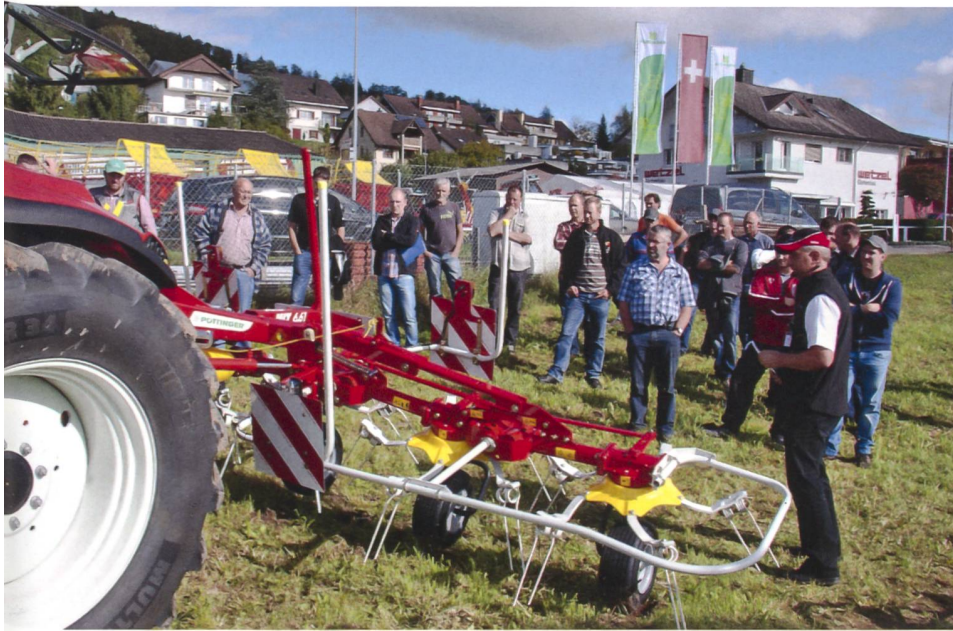
Speaker Stefan Burger erklärt an der Herbstmesse in Birnenstorf AG die Ausstattungen des Sechskreiselzeters HIT 6.61 mit 5,75 m Arbeitsbreite und 3,5 m Transporthöhe. (Bilder: Dominik Senn)
