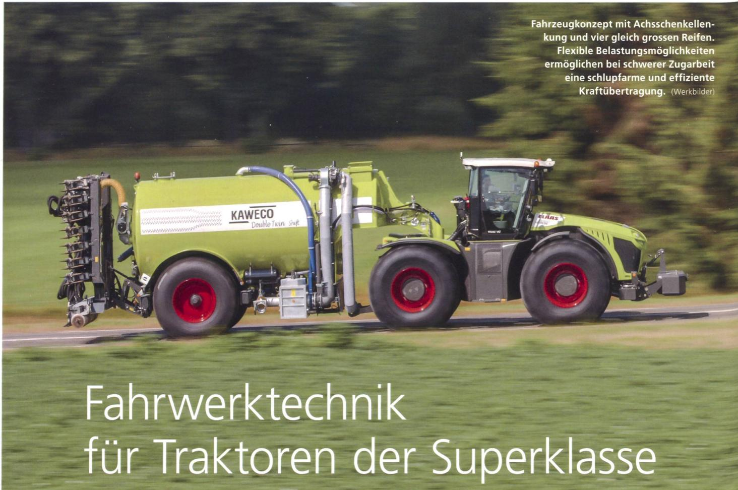
Fahrzeugkonzept mit Achsschenkellenkung und vier gleich grossen Reifen.
