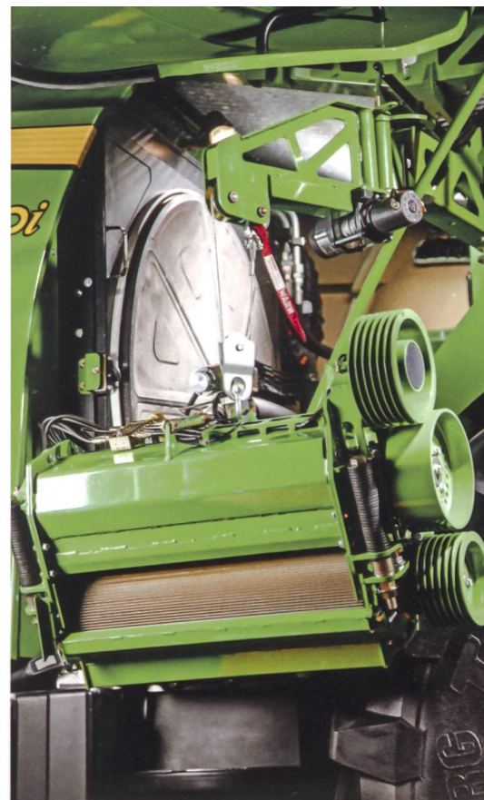
Für den Komplettausbau des Körnerprozessors steht ein integrierter Kranausleger mit Elektroseilwinde zur Verfügung. Der Prozessor kann damit direkt auf den Boden neben der Maschine gestellt werden.
