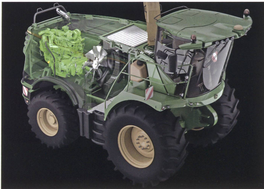
Aufgrund der mittigen Anordnung der Kühleinheit konnte der weiterhin in Längsrichtung eingebaute Motor sehr weit hinten angeordnet werden, wodurch wesentlich weniger Heckballast erforderlich ist.
