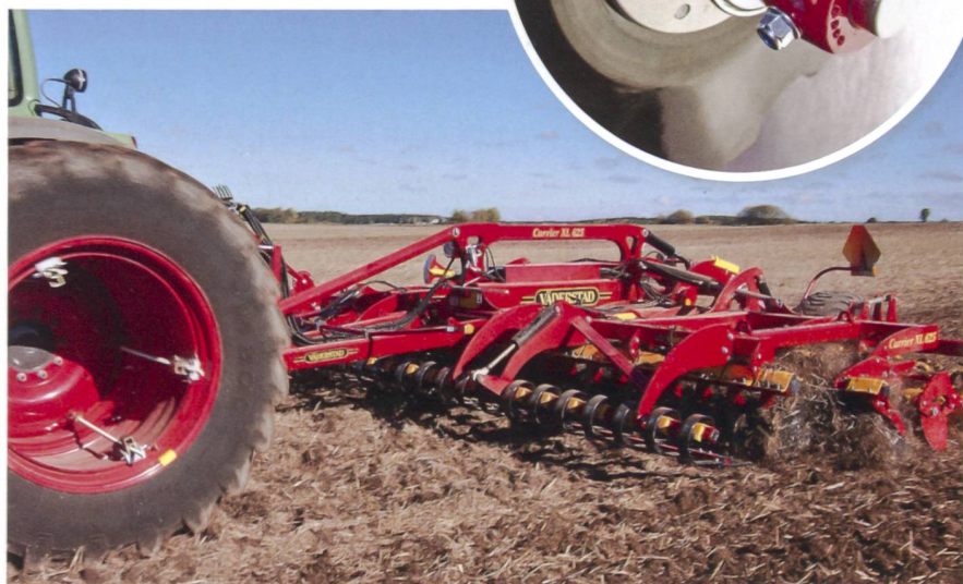
Die neue Carrier L und XL kommen mit sehr grossen Mengen organischer Substanz zurecht, wobei auch die Scheiben von 51 cm beziehungsweise 61 cm Durchmesser ausgetauscht werden können. Rundes Bild: elegante Konstruktion MulitSet mit dem der Anstellwinkel der Scheiben mit wenigen Handgriffen verstellt wird.
