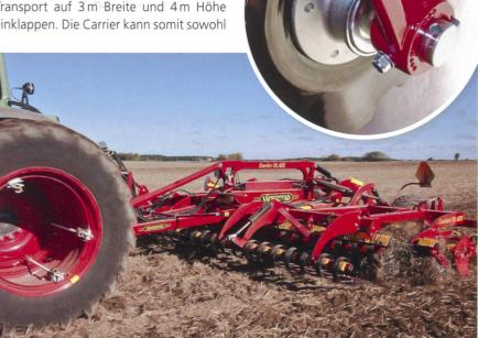
Die neue Carrier L und XL kommen mit sehr grossen Mengen organischer Substanz zurecht, wobei auch die Scheiben von 51 cm beziehungsweise 61 cm Durchmesser ausgetauscht werden können. Rundes Bild: elegante Konstruktion MulitSet mit dem der Anstellwinkel der Scheiben mit wenigen Handgriffen verstellt wird.
