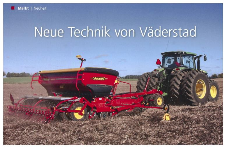
Weiter entwickelte Baureihe Rapid 300 und 400 C/S. Ein wesentlicher Unterschied zwischen dem vorherigen System Disc und dem neuen System Disc Aggressive sind die grösseren konischen Scheiben (450 mm verglichen mit 410 mm) mit einem aggressiveren Antellwinkel. Dies bringt zusätzliche Vorteile zum Einmischen von Pflanzenmaterial. (Bilder: Ueli Zweifel)
