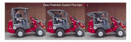
Durch hydraulisch in der Höhe absenkbare Schutzdächer von Weidemann und Thaler ist eine deutliche Verbesserung des Arbeitsschutzes des Benutzers gewährleistet. Durch die Absenkmöglichkeit wird nicht mehr, wie in der Praxis häufig üblich, der Schutz komplett und dauerhaft demontiert, um niedrige Durchfahrten zu passieren. Der Schutz für den Fahrer bleibt auch im abgesenkten Zustand bestehen. Die sichere Bedienung erfolgt im Stillstand durch eine 2-Hand-Bedienung.
