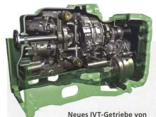
Neues IVT-Getriebe von John Deere für die Baureihe 7R. Charakteristische Merkmale sind die Doppeljoch-Hydrostatik (links) und der zusammengesetzte Planetensatz (Bildmitte).
