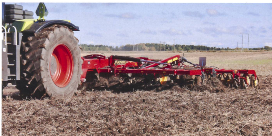
Auf schwedischem Acker: Der Grubber Opus arbeitet bis in eine Tiefe von 40 cm und bewältigt grosse Mengen an organischer Masse.
