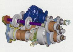
Neues CNH-Getriebe für die Grosstraktoren Case IH Magnum und New Holland T8. Die vier Fahrbereiche werden über vier Lamellenkupplungen geschaltet (orange, links unten), der Fahrtrichtungswechsel erfolgt über zwei weitere Lamellenkupplungen (orange, rechts im Bild).
