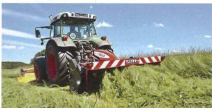
über die gesamte Arbeitsbreite für eine schnelle, verlustarme Trocknung. Daraus resultiert eine hohe Qualität für eiweiß- und energiereiche Grassilagen und hohe Leistung der Milchkühe aus dem Grundfutter. Das Herz dieser Maschine ist ein neuer Zinkenaufbereiter mit 600mm Durchmesser.
