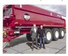
baut für den Dauereinsatz. In der Basisversion gibt es viele Möglichkeiten, sodass der Träger gegebenenfalls mit Tandem-Fahrwerk, Luft oder hydraulischer Federung ausgestattet ist. Die Hakenlifte werden mit einer Zugkraft von 14-15 bis auf Tandem-Fahrwerke gefertigt, der 30-t-Hakenlift wird auf ein 3-achsiges Beco-Fahrwerk gefertigt.
