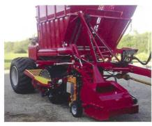
den sehr grossen Reifen. Zu den Vorzügen gehört insbesondere die robuste Bauart, weshalb die Maschine wartungsarm und damit sehr wirtschaftlich ist. Den Rübenvollernter TIM kann man mit angetriebenen Opalrädern oder mit Wippscharen kaufen. Der bis 14 Kubikmeter fassende Rollbodenbunker ist sehr schnell entleert. Die Maschine benötigt einen circa 90 PS starken Traktor und rodet in einer Stunde 0,3 bis 0,6 Hektaren.
