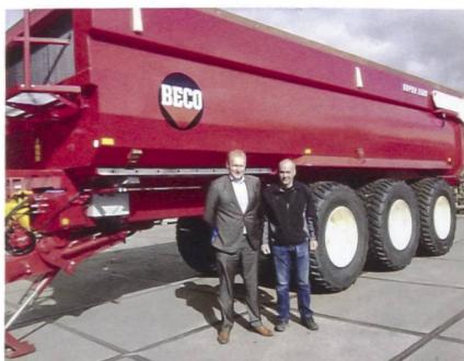
baut für den Dauereinsatz. In der Basisversion gibt es viele Möglichkeiten, sodass der Träger gegebenenfalls mit Tandem-Fahrwerk, Luft oder hydraulischer Federung ausgestattet ist. Die Hakenlifte werden mit einer Zugkraft von 14-15 bis auf Tandem-Fahrwerke gefertigt, der 30-t-Hakenlift wird auf ein 3-achsiges Beco-Fahrwerk gefertigt.
