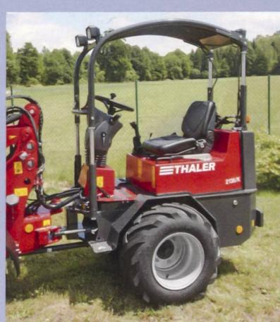
Modelle und 27er-Modelle. Das hydraulisch absenkbare Rops-Pops-Schutzdach ist auch nachrüstbar.
