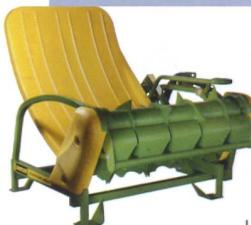
beitet ohne Kette. Die Bälle liegen auf einer Rutsche aus Kunststoff und wird von zwei Walzen gedreht und aufgelöst. Die beiden Walzen arbeiten gegeneinander, die Zähne, welche das Futter auflösen, sind selbstreinigend. Die Produkte von Hustler sind Auflöser und Spitz in einem. Ballenspitz und Auflöser werden, ohne abzusteigen, getrennt oder gekoppelt. Der für den Antrieb notwendige Hydraulikmotor sitzt auf dem Ballenspitz und verbindet sich beim Koppeln automatisch mit der Auflöser.
