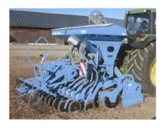
füllung und Entleerung wurden bei der Konstruktion bedacht. Das stabile Rollscharsystem erreicht 50 kg Schardruck und ist mit grossen 320er-Andruckrollen ausgestattet. Die exakte Saattiefe wird in Sekunden an der Einstellskala eingestellt. Die Kreiseleggen CARBID sind mit werkzeuglosem Zinkenschnellwechsel und parallel geführten Seitenschilden ausgerüstet. Die Rückverfestigung im Ablagebereich der Saat durch die Axon Walze garantiert gutes Wachstum auch bei starker Trockenheit.
