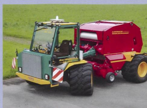
satzstärkere Version der Maisballenpresse mit 1,25 m³ Ballenvolumen vorgestellt. Diese zeichnet sich dadurch aus, dass sie mit 15kW nur etwa einen Zehntel der Antriebsleistung einer Rundballenmais presse benötigt.
