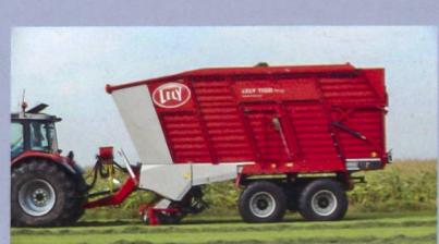
bau bietet ein Höchstmaß an Stabilität und macht ihn zum kompaktesten Silierwagen in seiner Klasse. Dadurch bietet Lely dem Anwender noch mehr Einsatzmöglichkeiten als bisher. Die schwenkbare Stirnwand bringt mehr Volumen und erleichtert das Entladen.
