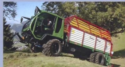
ohne Demontage von Anbaugeräten), eine Rückfahrkamera, Fronthydraulik mit Frontzapfwelle, nasse Mehrscheibenbremsen hinten und vorn, eine hydraulische Federung mit DLS-Aufhängung, absenk-, aushebe- und sperrbar, ein Dauermagnet-Retarder sowie ein Pendelchassis bis 50° Verdrehwinkel. Der Eurotrans bietet eine Nutzlast bis 7 Tonnen und bis zu 20 Tonnen Anhängelast.
