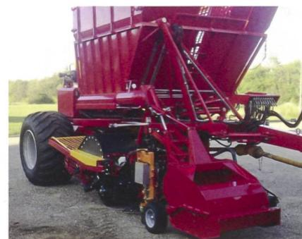
den sehr grossen Reifen. Zu den Vorzügen gehört insbesondere die robuste Bauart, weshalb die Maschine wartungsarm und damit sehr wirtschaftlich ist. Den Rübenvollernter TIM kann man mit angetriebenen Opalrädern oder mit Wippscharen kaufen. Der bis 14 Kubikmeter fassende Rollbodenbunker ist sehr schnell entleert. Die Maschine benötigt einen circa 90PS starken Traktor und rodet in einer Stunde 0,3 bis 0,6 Hektaren.
