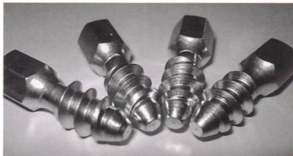
Grizzly-Snow-Stud-Schraubspikes bestehen aus einer verzinkten Schraube und einem hochverschleissfesten, eingelöteten Hartmetallstift. Das Schraubgewinde ist einzigartig, sodass sich der Spike fest verzahnt. Die Schraubspikes können mit dem Akkuschrauber montiert und demontiert werden, dies mehrere Winter lang. Der Fahrkomfort mit Schraubspikes ist uneingeschränkt und der Energieverbrauch erheblich tiefer als mit Ketten.
