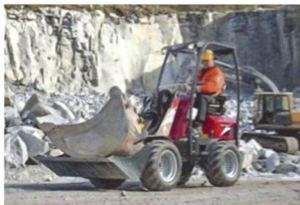
2,1 Tonnen bei einer Ladehöhe von bis zu 3,3m zeichnen diese Multifunktionslader aus. Die Parallelführung, der doppelte Hubzylinder sowie die Traktionskontrolle mit 4 Fahrantrieben von Poclain bringen Ihnen die Leistung, die Sie brauchen. Per Multifunktionsjoystick können 3-Punkt-Anbaugeräte am Heck sowie die Zusatzhydraulik am Teleskoparm angesteuert werden. Dank Hand- und Fuss-Gas kann die Leistung individuell Ihren Arbeiten angepasst werden.
