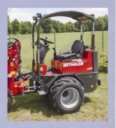
Modelle und 27er-Modelle. Das hydraulisch absenkbare Rops-Fops-Schutzdach ist auch nachrüstbar. Stand A015
