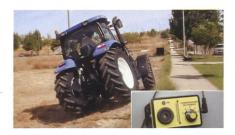
steil fahren will. Es ist anfangs mittels einer Inclisafe-Datenbank auf Traktor und Zusatzlasten abzustimmen. Ein Beispiel für diese Anwendungen sind Betriebe mit Lernenden oder Angestellten. Es kann klar definiert werden, dass das Fahrzeug zu stoppen ist, wenn Inclisafe Alarm schlägt.
