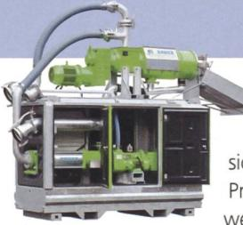
setzbar und eignet sich beispielsweise zur Produktion von hochwertiger Einstreu bei Rindergrüle, zur optimalen Aufbereitung von Schweinegülle, zur Substratgewinnung bei Biogasanlagen oder in der Lebensmittelindustrie zur Verwertung von Abfällen. Die Ausstattung: Separator, Exzenterorschneckenpumpe, Abführkreiselpumpe, elektronische Steuerung, Verrohrung, Verkabelung, montiert auf stabilem Rahmen mit Hubstaplervorrichtung bzw. Transportwagen.
