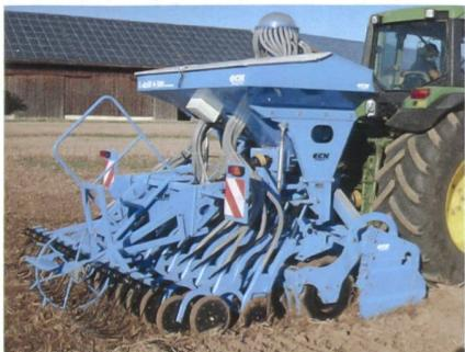
füllung und Entleerung wurden bei der Konstruktion bedacht. Das stabile Rollscharsystem erreicht 50kg Schardruck und ist mit grossen 320er-Andruckrollen ausgestattet. Die exakte Saattiefe wird in Sekunden an der Einstellskala eingestellt. Die Kreiseleggen CARBID sind mit werkzeuglosem Zinkenschlüsselwechsel und parallel geführten Seitenschilden ausgerüstet. Die Rückverfestigung im Ablagebereich der Saat durch die Axon Walze garantiert gutes Wachstum auch bei starker Trockenheit.
