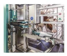
ab und schützt sie daher gegen Schmutz und Kuhtritte. Die Schlauchverbindungen sind so angebracht, dass sie gleichzeitig gut geschützt und erreichbar sind. Eine spezielle Sandwichbauweise macht das neue Milk-Rack leicht und gleichzeitig extrem stabil. Die Melkbecher können nicht auf den Boden fallen. Das beugt Verschmutzung vor und gewährleistet beste Melkhygiene. Eine weitere technologische Neuerung
