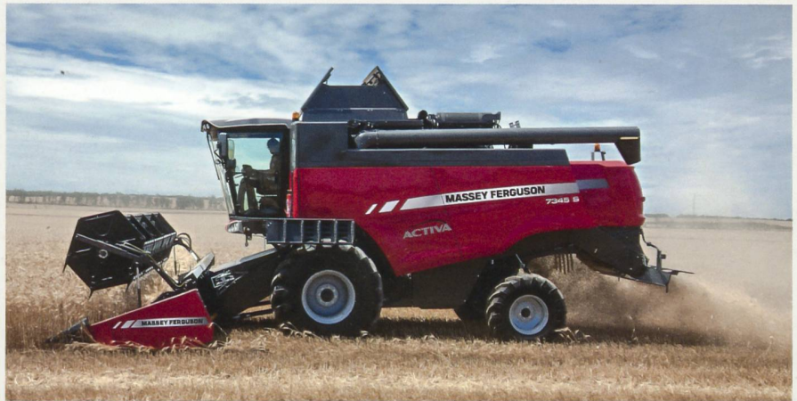
Der Mähdrescher Activa S 7345 mit fünf Schüttlern hat einen neuen AGCO-Power-Motor mit 243 PS Leistung erhalten.
