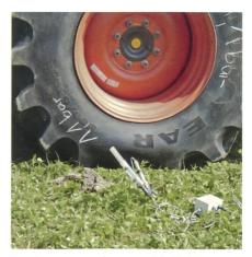
Druckmessungen in unterschiedlichen Bodentiefen.
