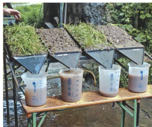
Erosion nach simuliertem Starkregen. (Bild: Ruedi Huber)
