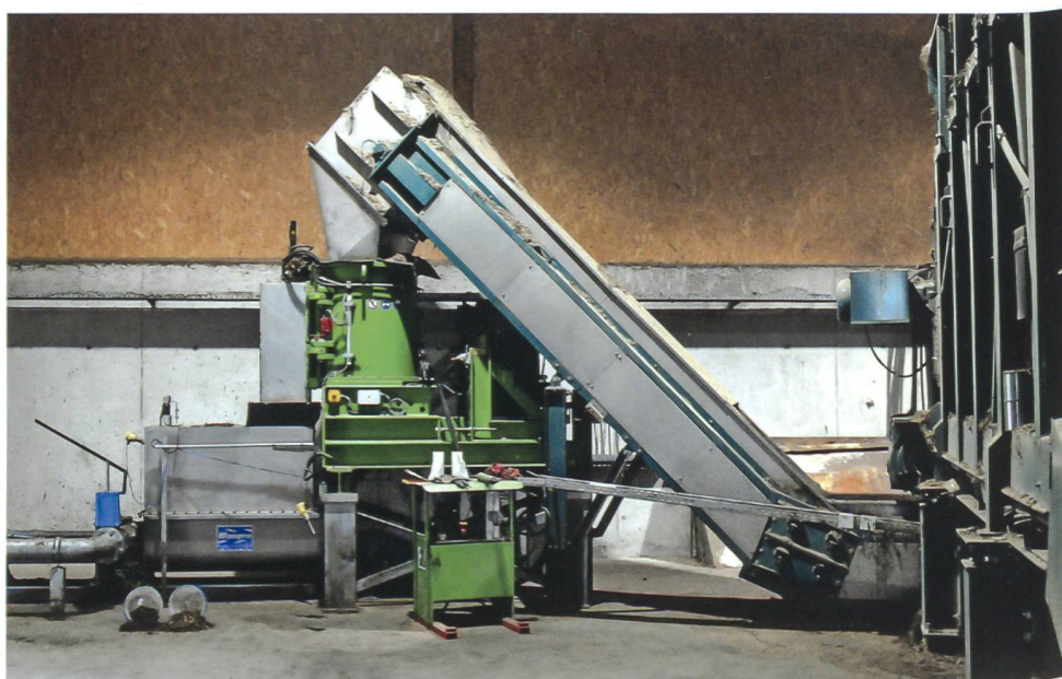
Vom Dosierbunker mit Waage (rechts) gelangt der Rohstoff über ein Förderband in den Bio-QZ und dann in die Beschickungspumpe.
