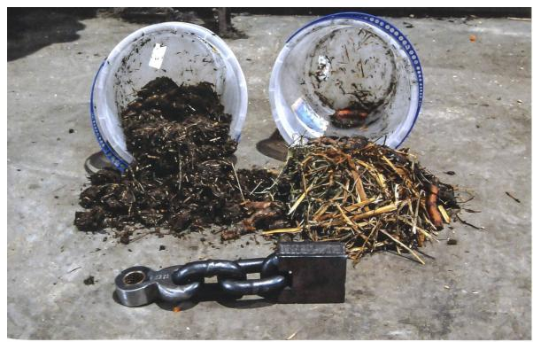
Durch den Kettenhammer wird aus verholztem Material (rechts) ein homogener und gut vergärbarer Rohstoff (links).
