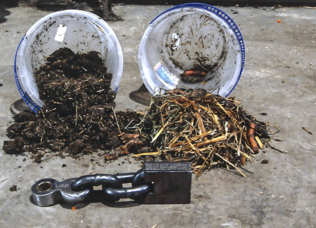
Durch den Kettenhammer wird aus verholztem Material (rechts) ein homogener und gut vergärbarer Rohstoff (links).
