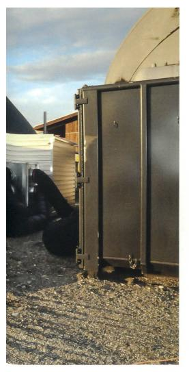
Mit der Wärme der Biogasanlage wird zurzeit eine Containertrocknungsanlage für bis zu sechs Container betrieben.
