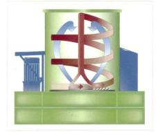
Wirkungsprinzip: Im Querstromzerfaser wird das faserige Material während rund 30 Sekunden zerkleinert.
