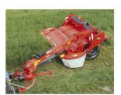
mit variabler Breite oder Breitstreuvorrichtung. (Bei der Breitablage des Futters kann man sich häufig einen Durchgang mit dem Heuer sparen. Sie findet daher immer mehr Anhänger.)
