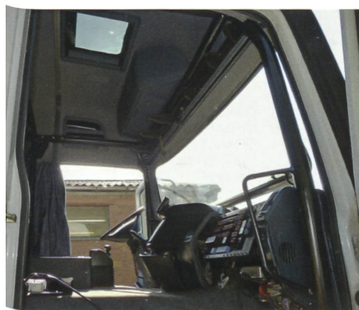
Damit der Lastwagen als Traktor eingelöst werden kann, fertigt Willi Signer nach den Vorgaben Schutzrahmen an und baut sie in die Kabine ein.
