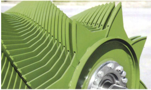
Die Förderzinken vieler Ladewagenrotoren sind mit verschleissfesten Hardox-Plättchen bestückt (links) oder ganz aus verschleissfestem Material. Die Spitzen sind bei Strautmann (rechtes Bild) mit einem zusätzlichen Hartauftrag geschützt. (Bilder: zvg)
