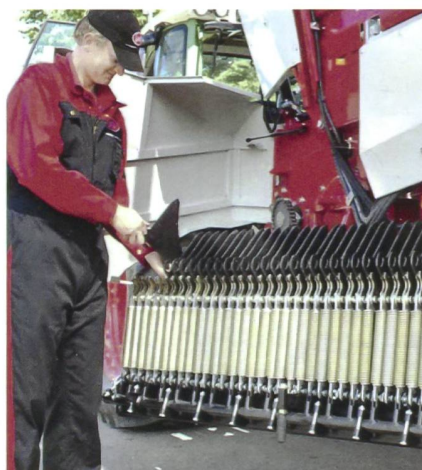
Bei diesem Modell von Lely wird der Messerbalken inklusive Messersicherung komplett nach aussen geschwenkt.
