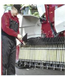
Bei diesem Modell von Lely wird der Messerbalken inklusive Messersicherung komplett nach aussen geschwenkt.
