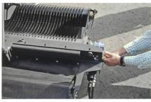
Mit dem Fine Cut Schneidwerk bietet Claas als einziger Hersteller einen Messerabstand von nur 20 mm für das sehr feine Schneiden von Stroh.
