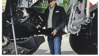
Beim neuen Cargos von Claas sind die neuen Zweischneidenmesser dank abgeklapptem Kratzboden bequem ohne Ausschwenken zugänglich. Nur bei Claas ist es möglich, den Kratzboden zum vollständigen Entleeren nach oben zu klappen.
