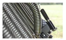
Bei vielen Messersicherungen kommen Federn zum Einsatz, die bei ausgeschwenktem Messer nur wenig Druck ausüben.
