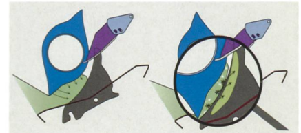
Für den neusten Integralrotor patentierte Kuhn eine «schleppende» Zinkenform (blau) die einen speziellen ziehenden Schnitt auf der ganzen Schneidekante des Messers (grau) ermöglichen soll.
