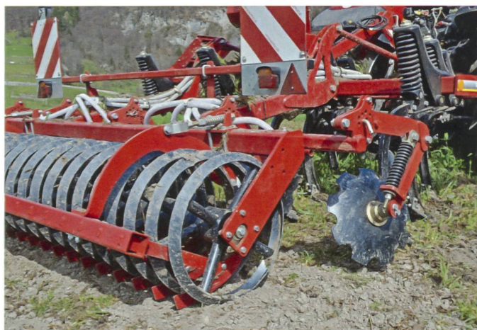
Einzel aufgehängte Einebnungsscheiben und der RollCut-Packer hinterlassen eine ebene und saarfähige Ackeroberfläche.
