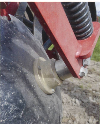
Die Scheiben sind dank einer Ölfüllung wartungsfrei gelagert.
