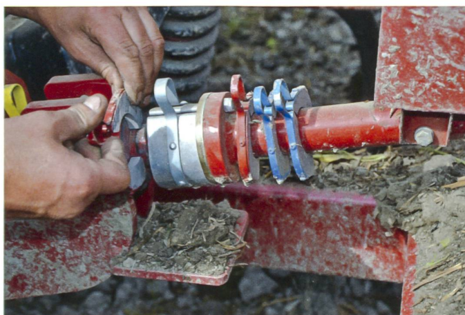
Geschützt unter einer Abdeckung sind die Alu-Clips zu finden, mit denen durch Umstecken indirekt die Arbeitstiefe verändert wird.
