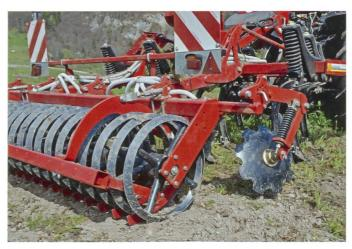
Einzeln aufgehängte Einebnungsscheiben und der RollCut-Packer hinterlassen eine ebene und saatfähige Ackeroberfläche.
