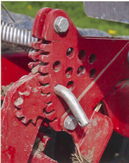
Die Einebnungsscheiben werden durch Drehen der Verzahnung verstellt und mit dem Bolzen gesichert. Dazu wird ein Ringschlüssel benötigt. Bilder Ruedi Hunger
