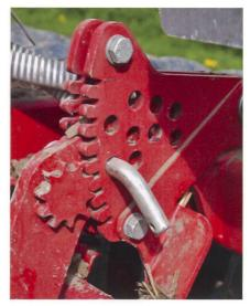
Die Einebnungsscheiben werden durch Drehen der Verzahnung verstellt und mit dem Bolzen gesichert. Dazu wird ein Ringschlüssel benötigt. Bilder Ruedi Hunger
