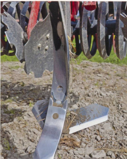
Die MulchMix-Schar besteht aus der Scharspitze, dem wechselseitig gedrehten Leitblech und einem linken und rechten Flügel.
