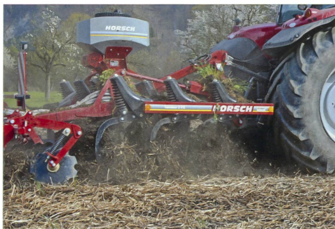
Innerhalb des Grubbers ist genügend Platz vorhanden, und die Erde kann vorbildlich «fliessen». (Bilder: Ruedi Hunger)
