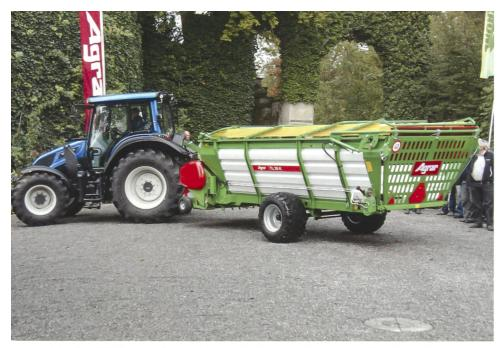
Die Chassisbreiten wurden so gewählt, dass mit einer breiten Bereifung (19.0/45-17) eine Aussenbreite von maximal 2,55 m nicht überschritten wird. (Bilder: Ueli Zweifel)
